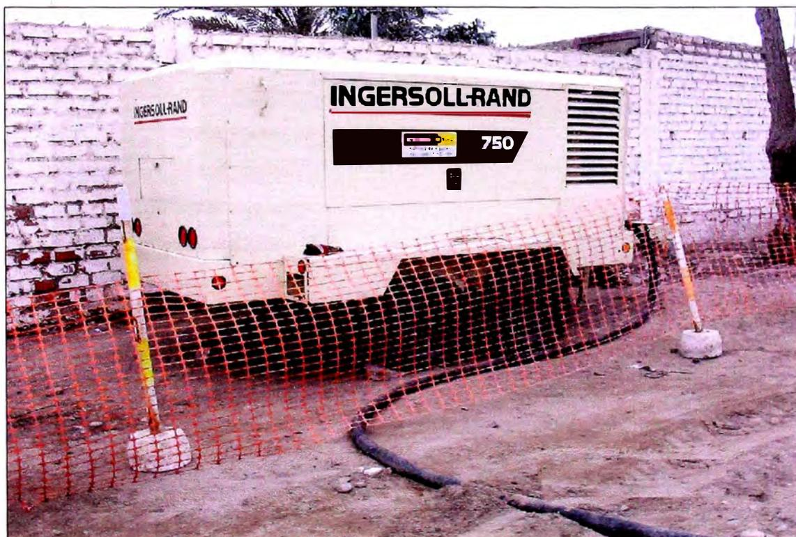
Figura N° 20: Compresor utilizado para impulsar pig de limpieza
