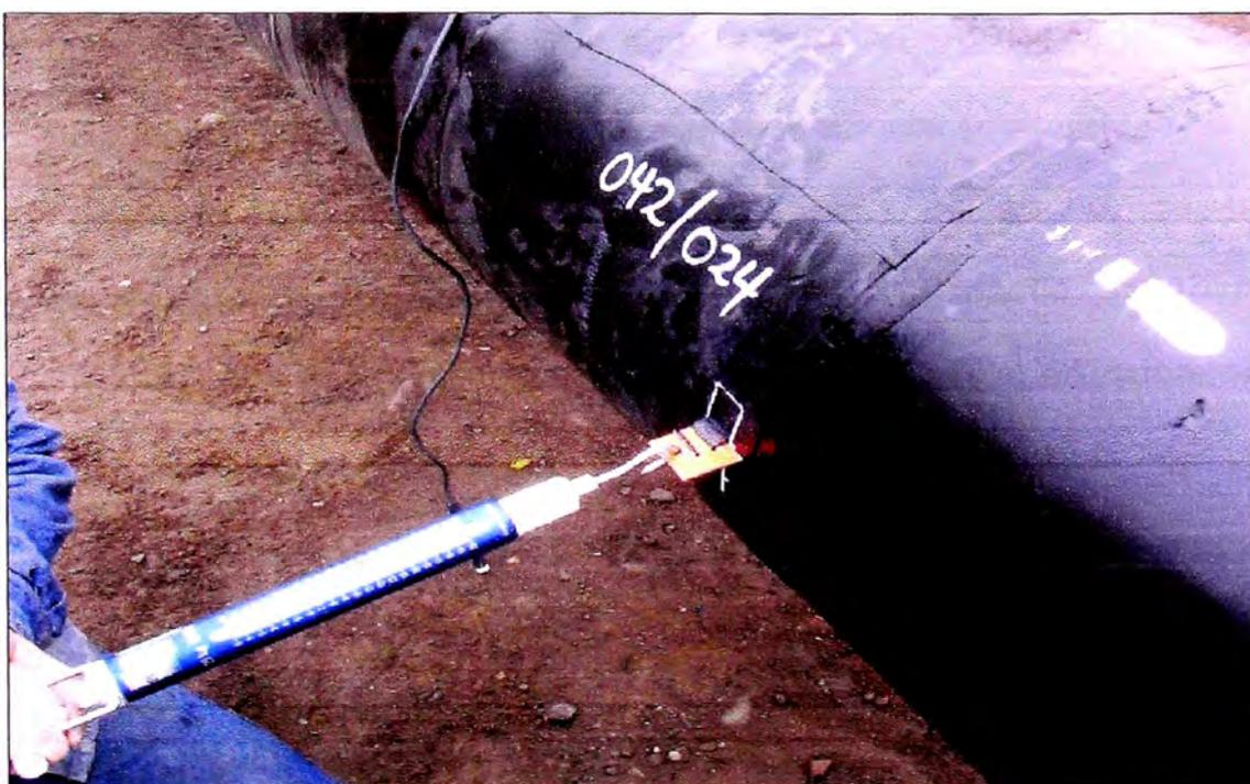
Figura N° 14: Ensayo de Adherencia
