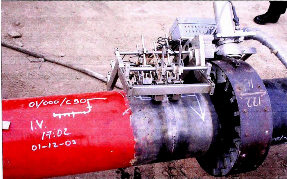
Figura N° 8: Análisis de junta de soldadura por ultrasonido
