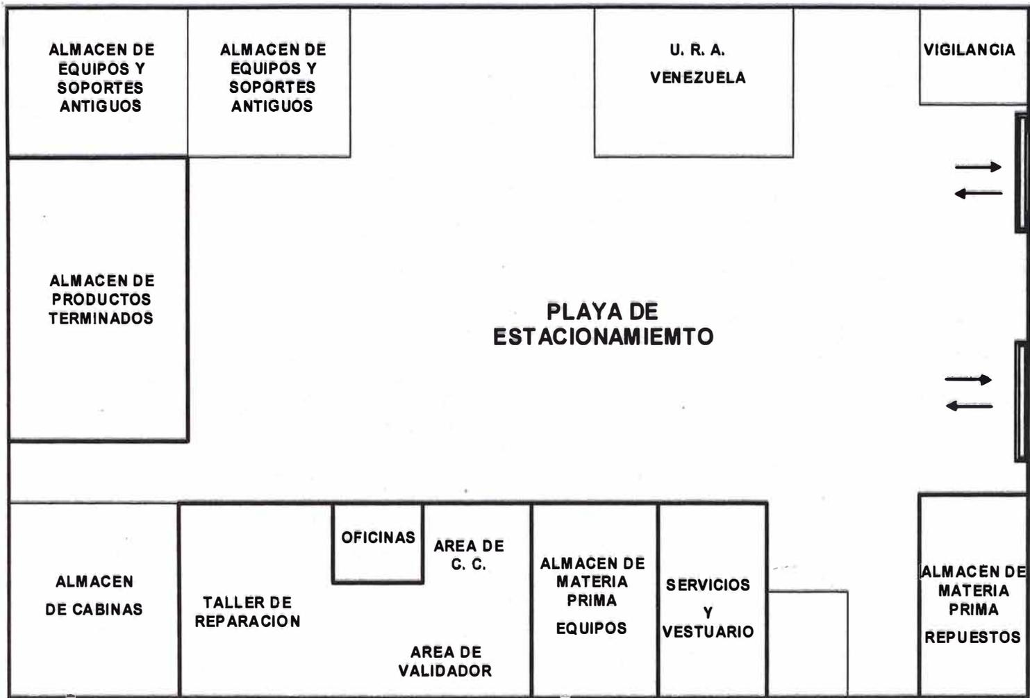
Figura 2.2 Plano Esquemático de la distribución de Taller actualmente
