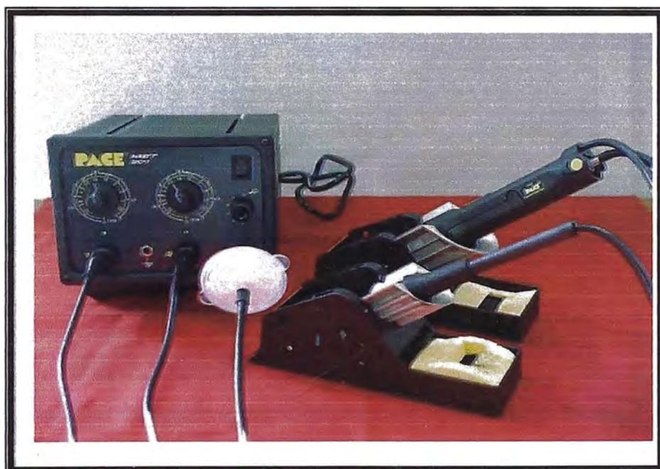
Figura 2.8.- Estación de soldadura MBT 201
