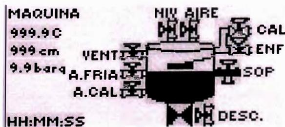
Permite ver una simulación gráfica del tanque de Máquina y también ver la temperatura , nivel y presión reales y el tiempo del paso.
