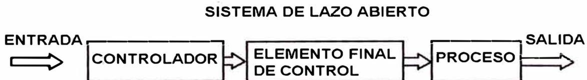
Un ejemplo de un sistema de control de lazo abierto sería un calentador de agua por intercambio de calor. Una persona opera de la manera que más conviene le parece la apertura o cierre de una válvula de entrada de vapor, basado en una adecuada información de carga para tratar de mantener la temperatura deseada de agua.
