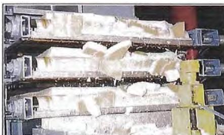
Figura 2.7 Descarga de Torta en un Filtro de Presión [7]
