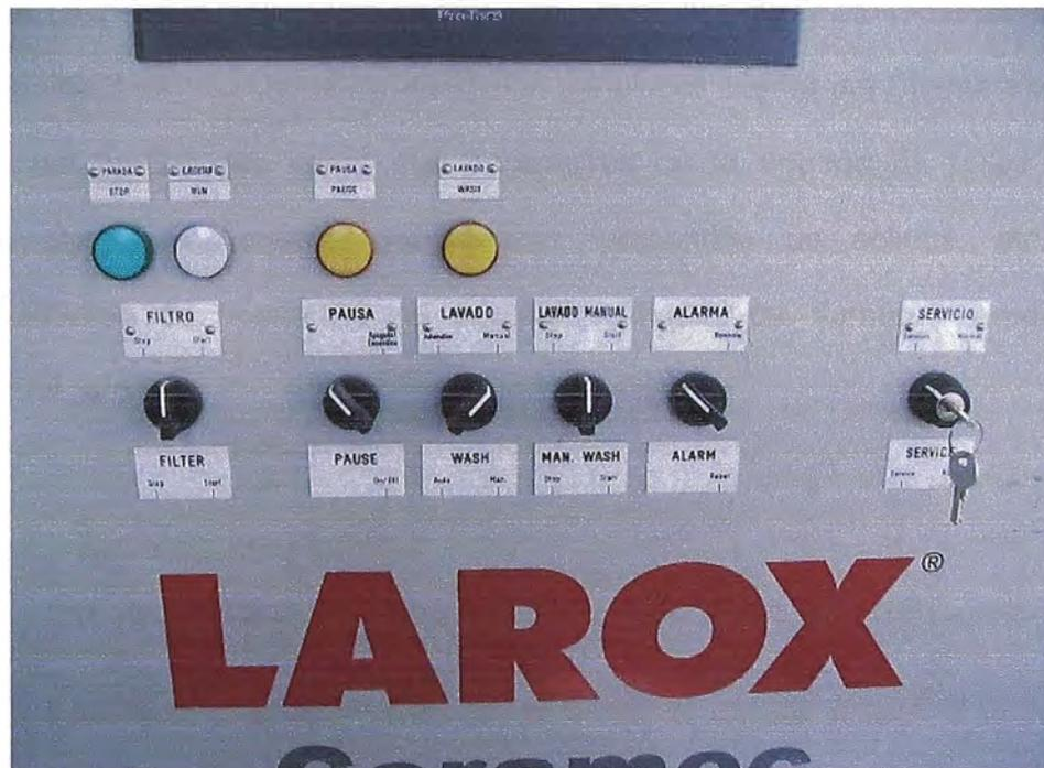
Figura 5.17 Botoneras e interruptores sobre el Panel de Control
