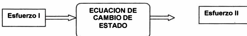
Los conductores se deben tensar de modo que, sin importar la condición climática imperante, su tensión nunca supere la máxima admisible. Intuitivamente se puede establecer que si la temperatura es baja, la flecha es reducida y la tensión mecánica elevada y en cambio si la temperatura es alta el cable se afloja y por lo tanto la flecha es elevada.
