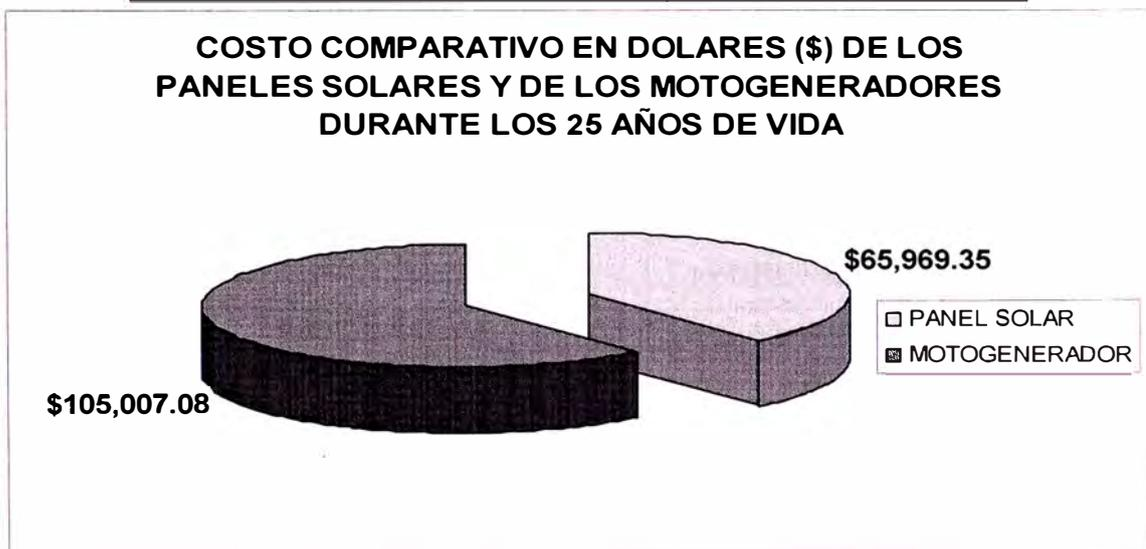
**Fig. 76 Costo Comparativo de los Paneles Solares y Moto Generadores**
