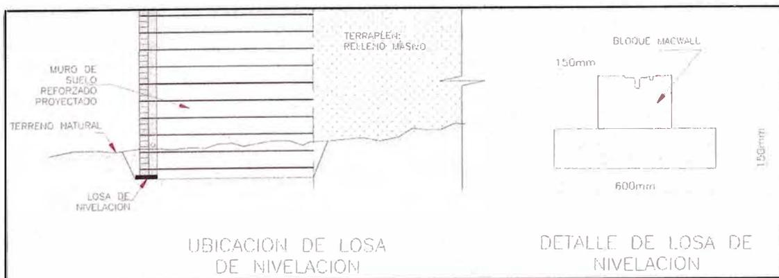
Figura N°1.12.- Muro de suelo reforzado – Losa de Nivelación.
