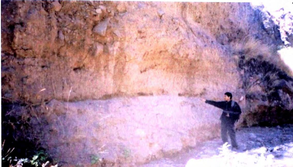
Fotografía 4.2. Marca de agua registrada en ambas márgenes de la quebrada a 290 metros aguas arriba de la confluencia. Altura aproximada de 1.80 m.
