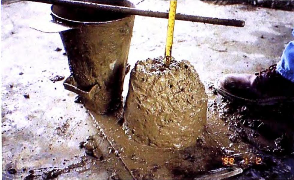
FOTOGRAFIA N°5 DETERMINACION DEL ASENTAMIENTO DEL CONCRETO CON CENIZA VOLANTE.
