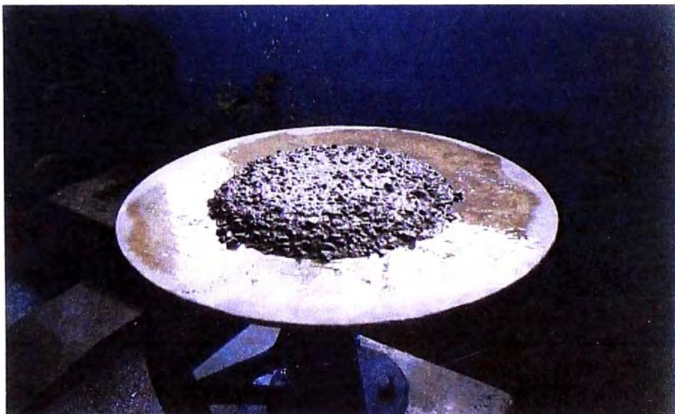
FOTOGRAFIA N°6 DETERMINACION DE LA FLUIDEZ DEL CONCRETO CON CENIZA VOLANTE
