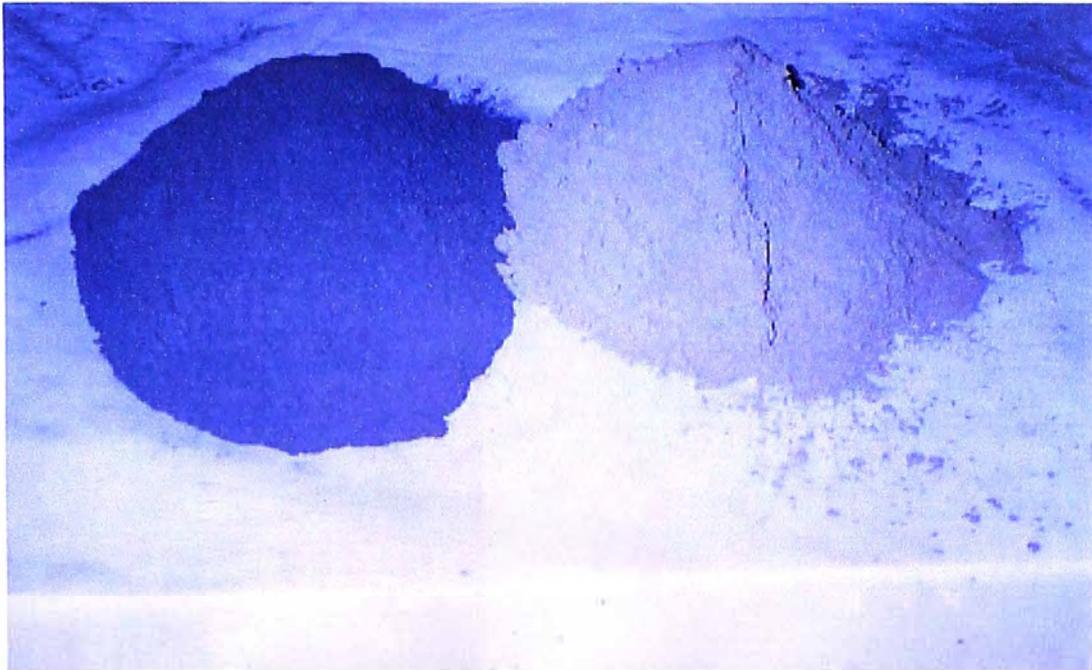
FOTOGRAFIA N°1.- CENIZA VOLANTE TIPO F A LA IZQUIERDA Y CEMENTO PORTLAND SOL TIPO I A LA DERECHA
