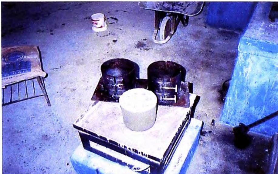
FOTOGRAFIA N°8 MOLDES UTILIZADOS PARA DETERMINAR EL TIEMPO DE FRAGUA DEL CONCRETO CON CENIZA VOLANTE
