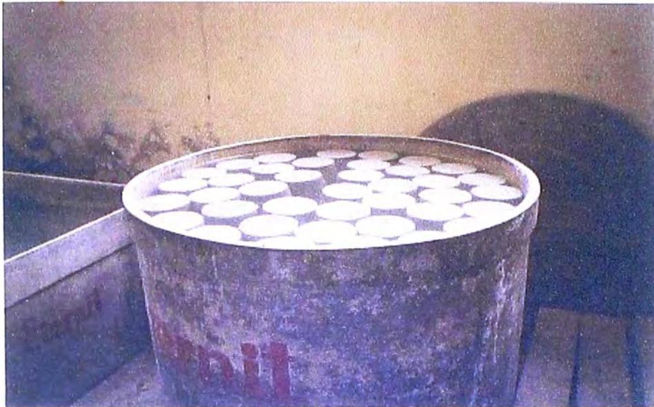
**FOTOGRAFIA N°9 CURADO DE LAS PROBETAS FABRICADAS PARA SER ENSAYADAS A COMPRESION AXIAL Y DIAMETRAL.**
