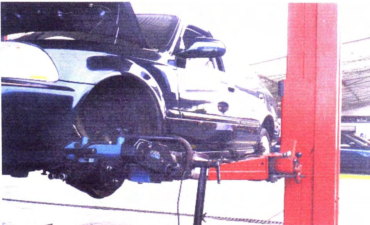
**FIG. 2.12 RECTIFICADOR DE DISCOS**
