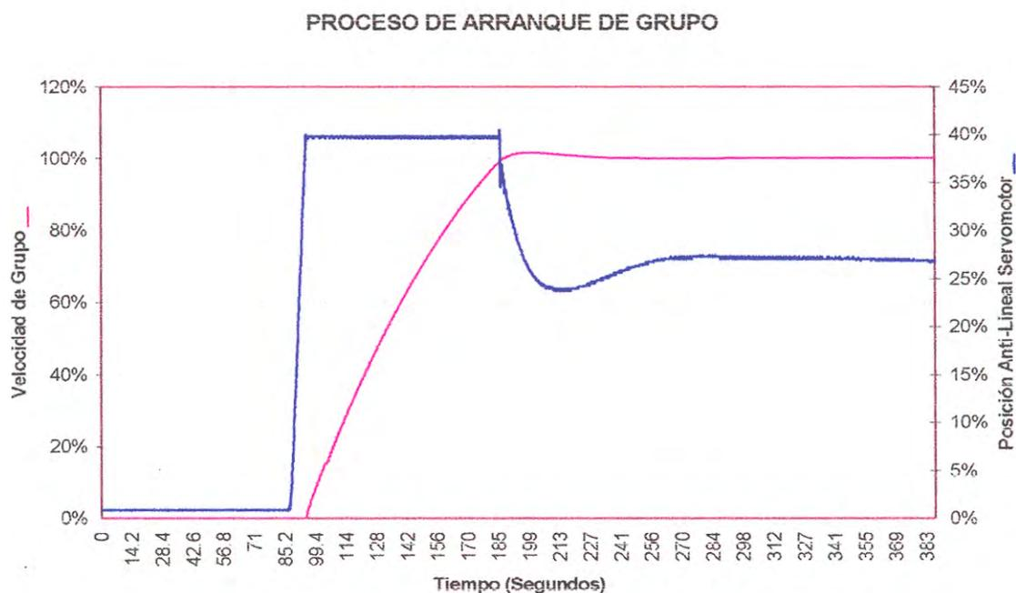
**Figura 9.1** Arranque de grupo hasta marcha en vacío
