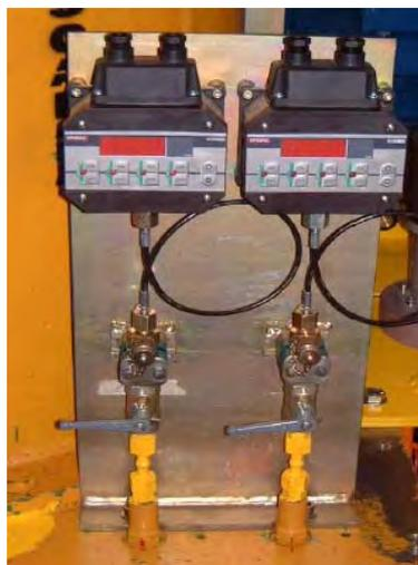
**PRESOSTATOS DIGITALES PARA LA MEDICIÓN DE PRESIÓN DE ACEITE**
