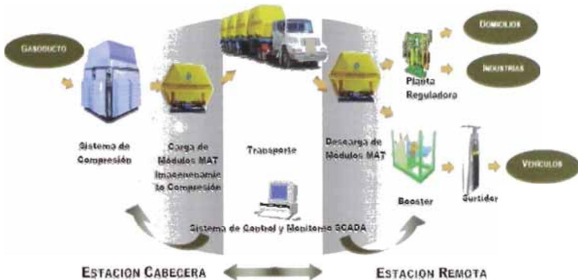
**Fig. 2.15.- Instalación de una Estación de Servicio con Gasoducto Virtual**
