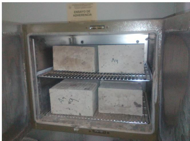
Figura 5.18. Muestras de UB-IAA en el horno secándose a 110 °C.
