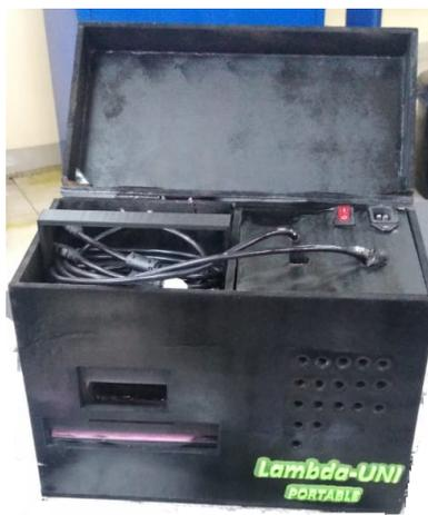
**Figura B.1.** Aparato portátil para medir conductividad térmica de materiales sólidos aislantes.
