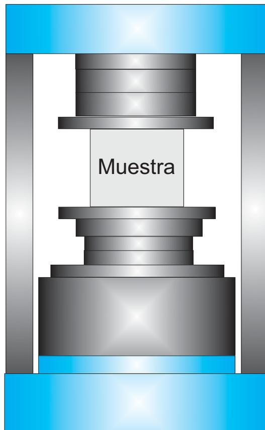
**Figura 4.22.** El bosquejo de un equipo para el ensayo de resistencia a la compresión a la unidad.
