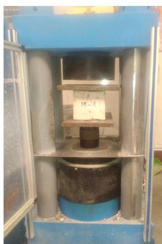
**Figura 5.19.** Máquina de compresión uniaxial, ubicada en el Laboratorio de Ensayo de Materiales de la Facultad de Ingeniería Civil de la UNI, ensayo para la UB-IAA.
