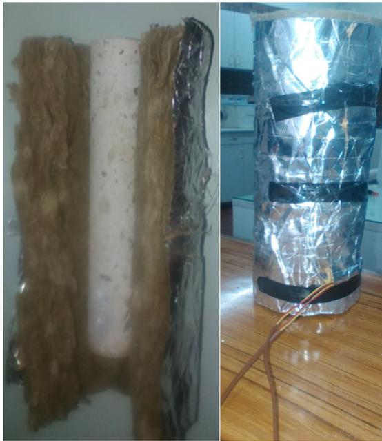
**Figura 4.16.** En la parte izquierda se observa la muestra UB-IAA con el aislante preformado de lana de roca cubierto con papel de aluminio o *foil*, y en la derecha se puede observar completamente cubierto y con las salidas de los termopares tipo K que ingresan hasta la mitad del diámetro.
