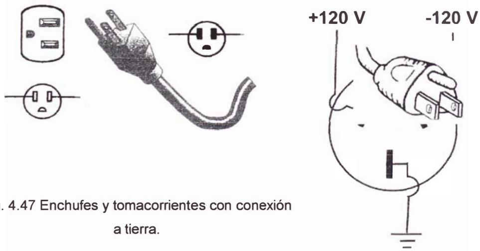
Fig. 4.47 Enchufes y tomacorrientes con conexión a tierra.
