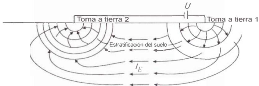
Fig. 2.6 Distribución de Corriente dentro de la tierra
