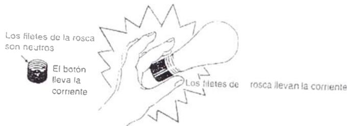
Fig.4.56 Riesgos de la polaridad invertida en el receptáculo de una lámpara : (a) Receptáculo alambrado correctamente; (b) Receptáculo con polaridad invertida.
