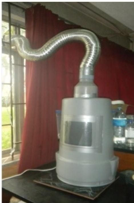
**Figura 3.2:** Conjunto cámara de protección en el proceso de síntesis y evacuación de gases.
