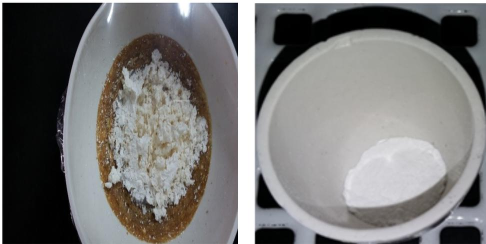
**Figura 3.5:** Izquierda Producto obtenido en el proceso de síntesis de  $YAlO_3$  inmediatamente después del proceso de síntesis. Derecha: Producto a analizar.
