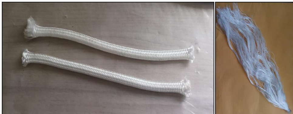
Figura 10.16. Cuerdas de polipropileno de \varnothing 3/8 pulg. y 35.5 cm de longitud, en la imagen de la izquierda se aprecia las cuerdas seccionadas y en la imagen de la derecha una cuerda deshilachada en hebras.
