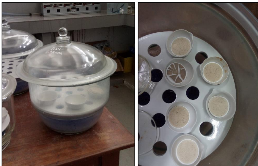
Figura 10.32. A la izquierda se observa el desecador con las muestras en proceso de secado, y a la derecha se aprecia las muestras secas y enfriadas, listos para su pesado correspondiente.
