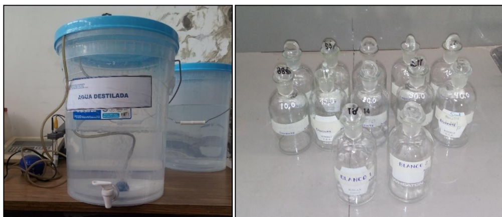
Figura 10.26. En la imagen de la izquierda se observa la aireación del agua de dilución, en la derecha los 12 frascos winkler, de los cuales 2 de ellos fueron usados como blancos y 5 frascos para las diferentes diluciones del afluente y otros 5 para el efluente.
