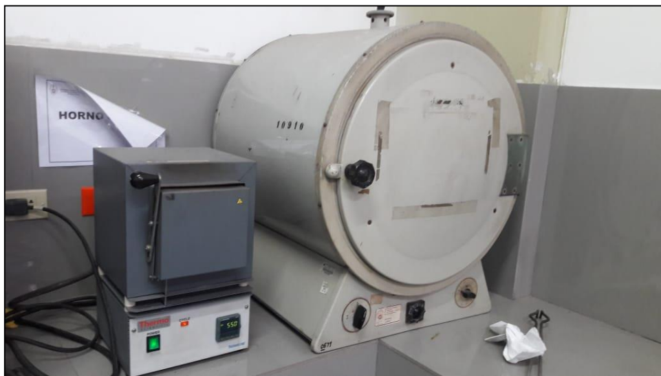
Figura 10.31. A la izquierda se observa el horno mufla que calcina a 550 °C y a la derecha se puede apreciar la estufa que calienta a 105° C.
