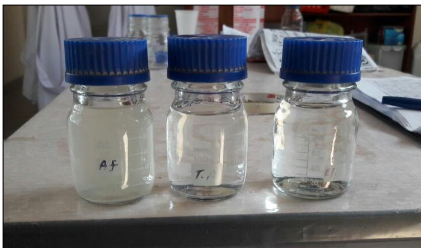
Figura 10.35. Muestras tomadas en el quinto escenario evaluado, se observa la baja concentración de SST en el tanque de aireación, es decir hubo poca biomasa suspendida y efluente muy clarificado.
