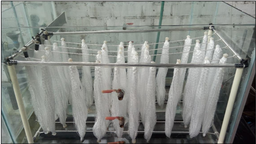
Figura 10.20. Medio de adherencia fijo instalado dentro del reactor de vidrio.
