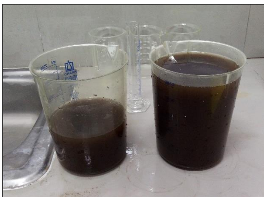
Figura 10.0. Biomasa extraída de las hebras de polipropileno, antes de la determinación de SST y SSV.
