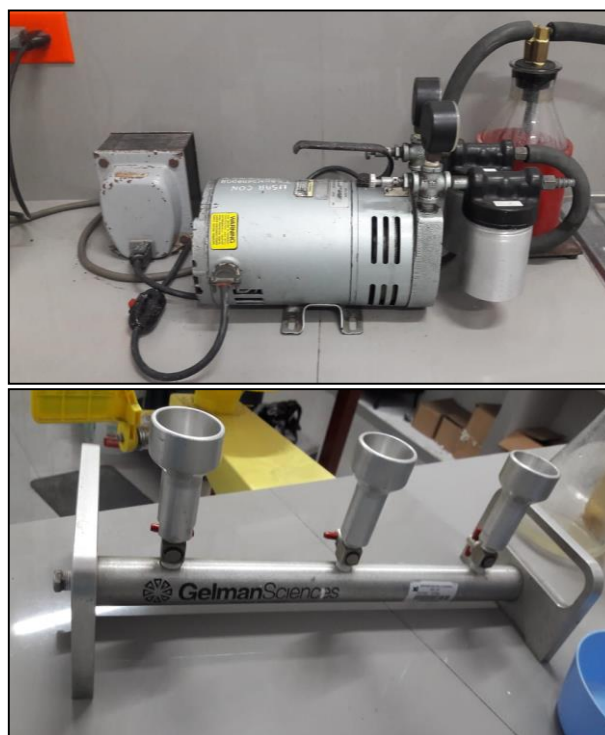
Figura 10.29. Compresor y tubo de vacío para el proceso de filtrado de las muestras.
