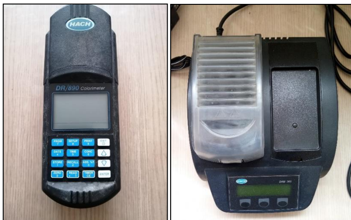
Figura 10.24. En la imagen de la de izquierda se observa en colorímetro HACH 890 en la cual se midió la DQO, nitrógeno amoniacal, nitritos y nitratos, en la derecha se aprecia en digestor de viales HACH DRB 200, el cual se utilizó para digerir los viales de DQO.
