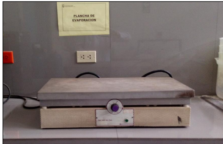
Figura 10.30. Plancha de evaporación de las muestras, calienta hasta 300 °C.
