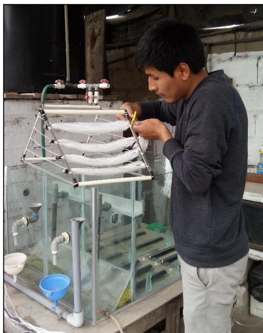
Figura 10.19. Elaboración del medio de adherencia fijo, que consistió en el tendido de cuerdas de manera horizontal en la parte superior e inferior del marco de soporte, luego se procedió a fijar las hebras de polipropileno de manera transversal, mediante el cosido manual con las cuerdas horizontales.
