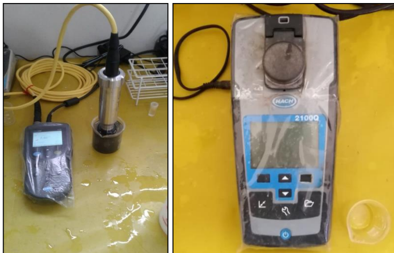
Figura 10.22. La imagen de la izquierda muestra el potenciómetro HACH AQ11D con el cual se midió el pH, y en la derecha se muestra en turbidímetro HACH 2100Q, equipo utilizado para la medición de turbiedad.
