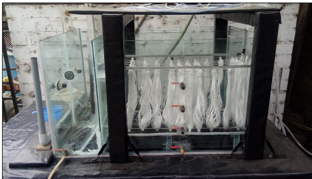
Figura 10.8. Reactor de vidrio de 6 mm de espesor con medio de adherencia fijo de hebras de polipropileno ancladas al soporte de acero inoxidable y tuberías de CPVC.
