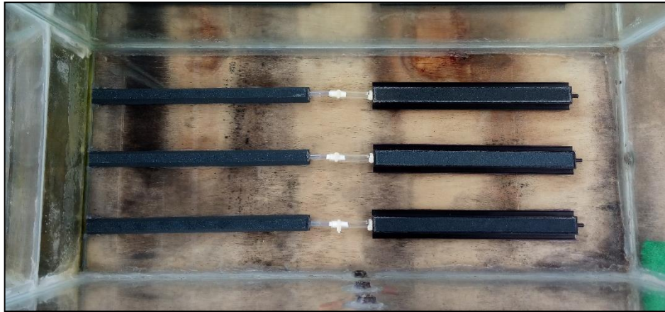
Figura 10.9. Disposición de los 6 difusores de piedra de burbuja fina, pegados en la base del reactor de vidrio.
