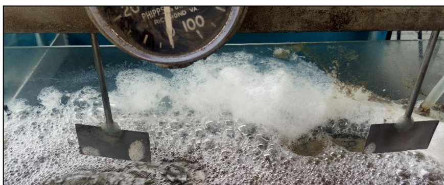
Figura 10.12. Detalle de paletas de acero inoxidable, operó con una longitud sumergida de 35 cm, por debajo del medio fijo y por encima de los difusores.
