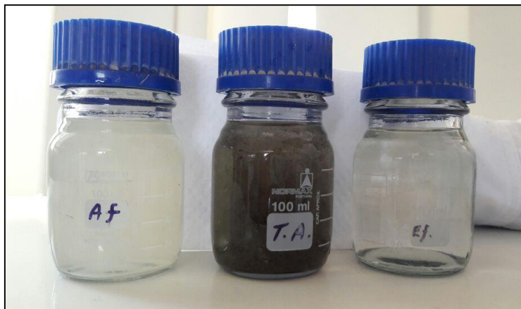
Figura 10.34. Muestras tomadas en el primer escenario evaluado, de izquierda a derecha se observa la muestra del afluente, tanque de aireación y efluente respectivamente, alta concentración de SST en el tanque de aireación, es decir alta biomasa suspendida y efluente regularmente clarificado.
