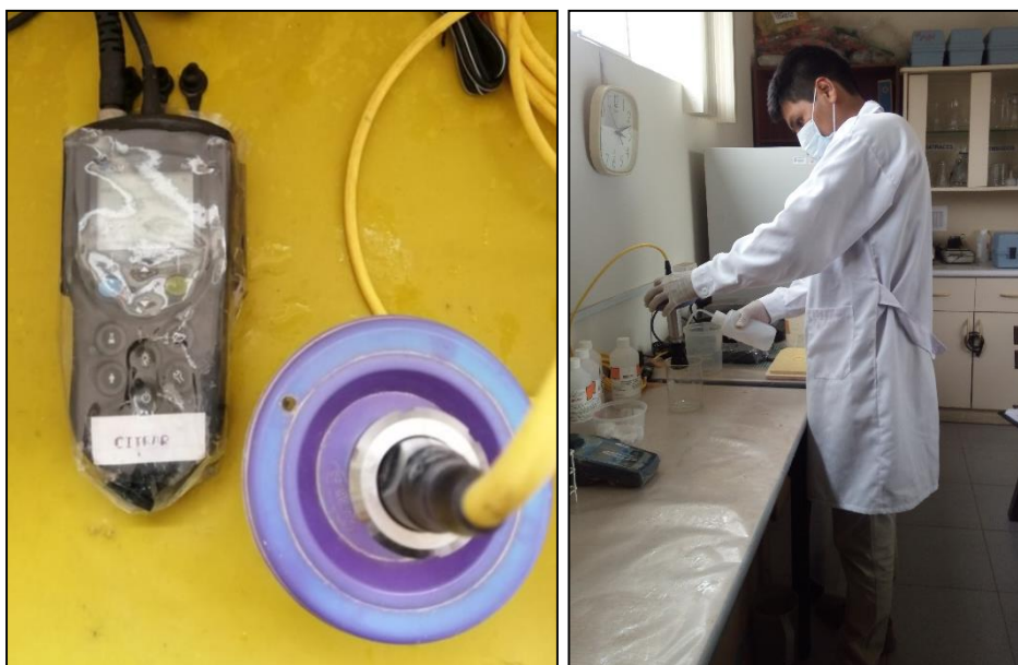
Figura 10.23. En la izquierda se observa el equipo HACH HQ40D, utilizado para la medición de oxígeno disuelto y temperatura de la muestra, en la derecha el proceso de medición.
