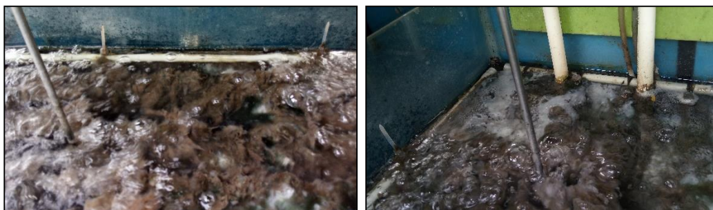
Figura 10.39. Fotografía del medio de adherencia fijo en el tercer escenario evaluado, tomada en la segunda semana, se caracterizó por presentar una biopelícula marrón durante todo el periodo evaluado.
