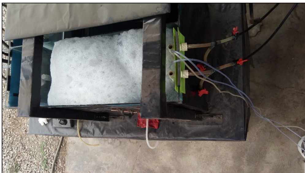
Figura 10.6. En la derecha de la imagen se muestra las dos mangueras de impulsión de Ø 3/8 pulg. con sus respectivas válvulas de paso y purga, además, se muestra la zona de ingreso en la que se aprecia las tuberías sumergidas.
