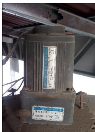
Figura 10.2. Motor de ventilador, adaptado para utilizarlo como mezclador homogenizador del tanque de almacenamiento, ubicado sobre la tapa del tanque, operó a 30 rpm.
