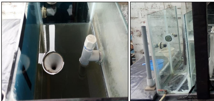
Figura 10.14. Sedimentador secundario, en la imagen de la izquierda se observa el interior del sedimentador donde está el vertedero de embudo y la tubería de ingreso sumergido al sedimentador, en la imagen de la derecha se observa una vista de perfil del sedimentador vacío.
