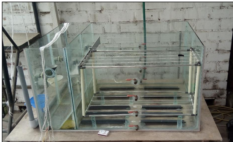
Figura 10.18. Encaje de prueba del marco de soporte apoyado sobre las cuñas de vidrio y dentro del reactor.
