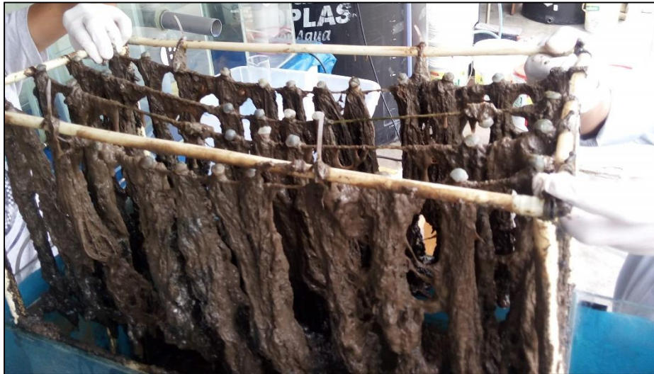
Figura 10.45. Fotografías del medio de adherencia fijo después de haber culminado los seis escenarios evaluados, donde se visualiza la biopelícula desarrollada.
