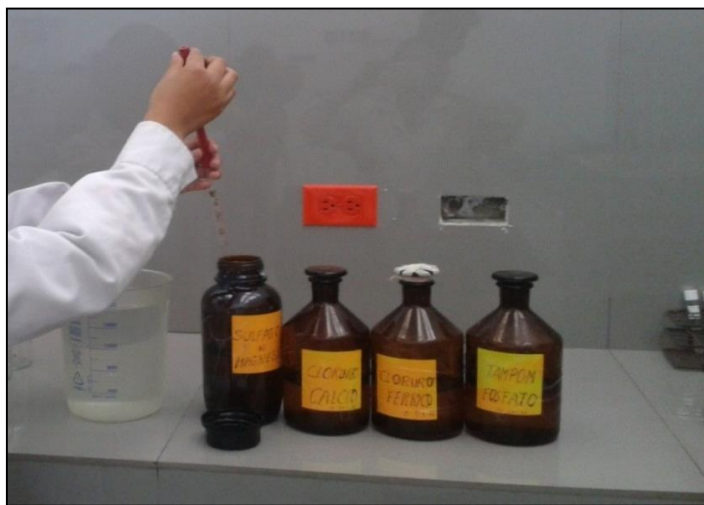
Figura 10.27. Proceso de adición de los 4 nutrientes al agua de dilución, 1 mL de cada uno por litro de agua destilada saturada en oxígeno.
