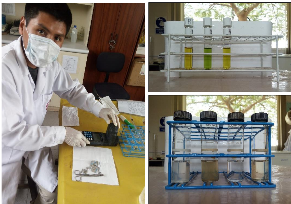
Figura 10.25. En la izquierda se aprecia el proceso de medición con el colorímetro y en la derecha los viales para la determinación de nitrógeno amoniacal y las celdas usadas para la determinación de nitritos y nitratos.
