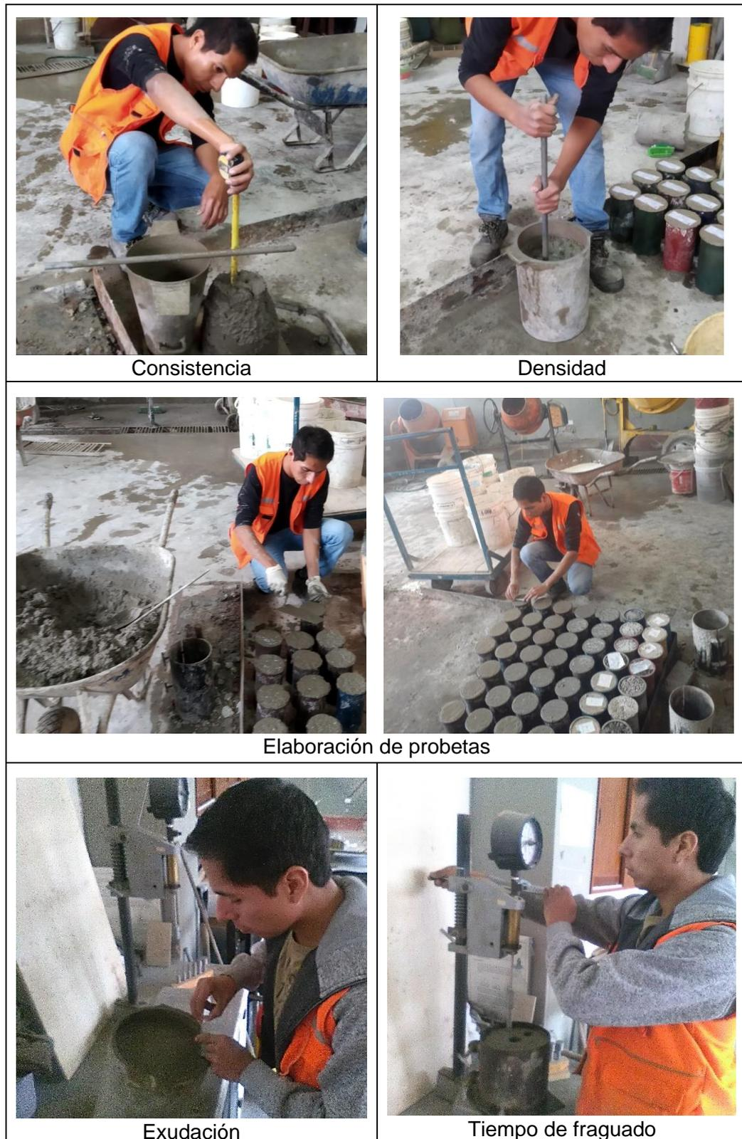
Figura 24. Área de mezclado (evaluación de las propiedades del concreto fresco y elaboración de probetas)
