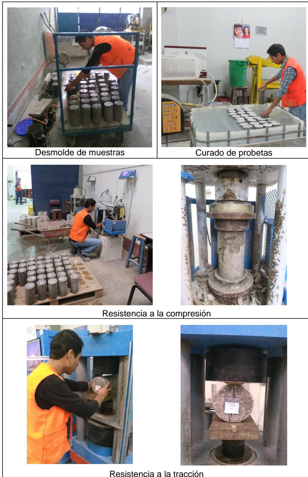
Figura 25. Curado de probetas y ensayos para determinar la resistencia mecánica del concreto
