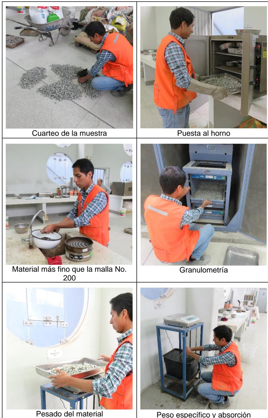
Figura 22. Área de agregados (preparación y evaluación de las propiedades del agregado grueso)
