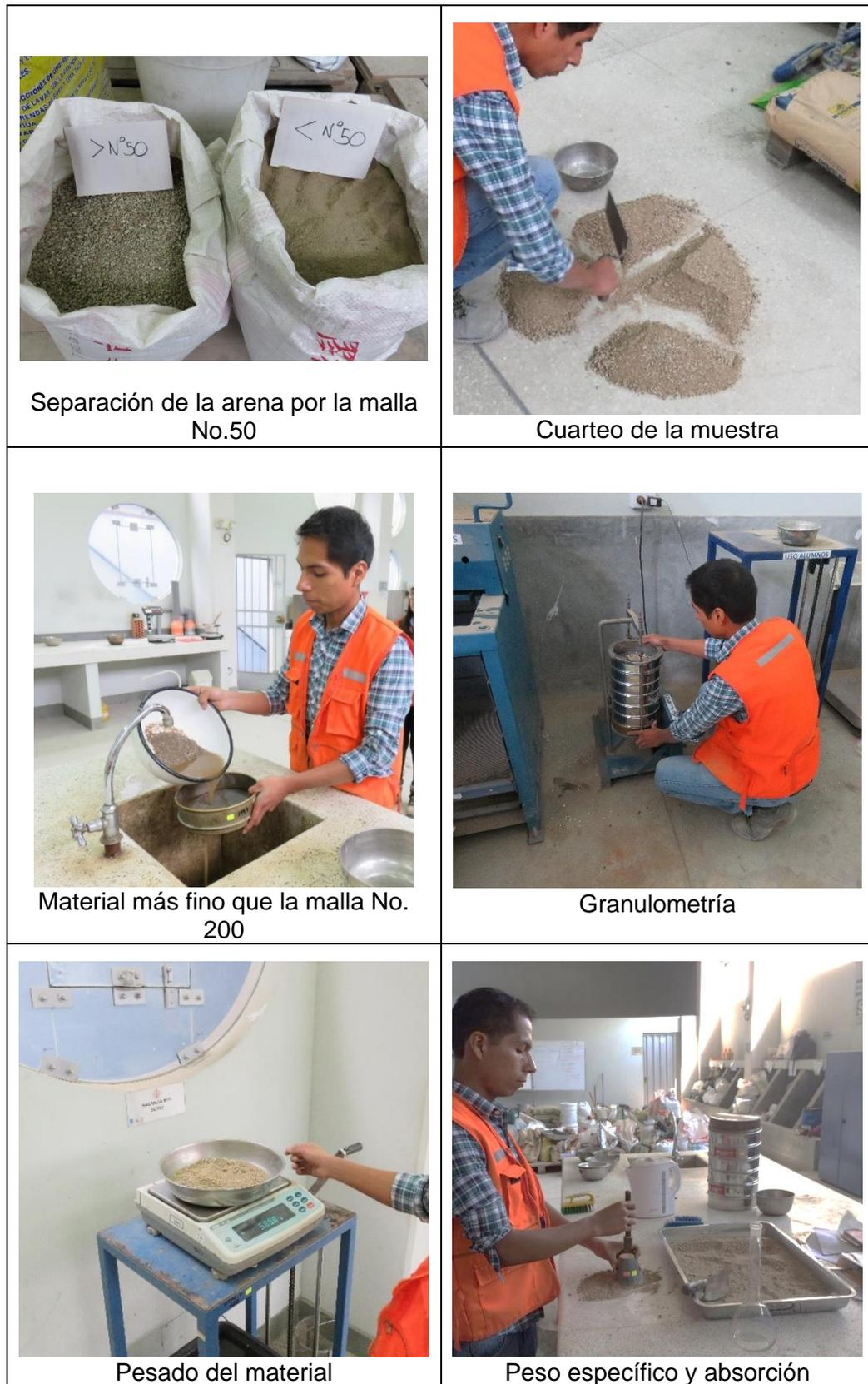
Figura 23. Área de agregados (preparación y evaluación de las propiedades del agregado fino)
