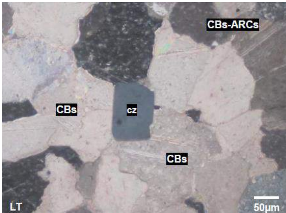
Figura 153. Cristal de cuarzo (cz) a manera de relictos atrapado entre los intersticios de los blastos de carbonatos que han sido impregnados incipientemente por agregados de arcillas (CBs-ARCs).
