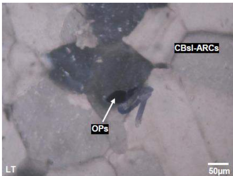
Figura 150. Cristal de minerales opacos (Ops) que han ingresado por las oquedades de los blastos de carbonatos I; estos últimos han sido impregnados incipientemente por agregados de arcillas (CbsI-ARCs).
