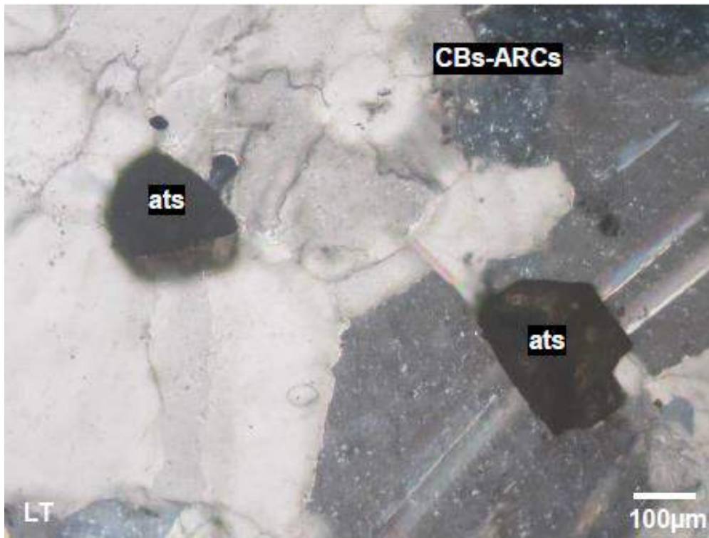
Figura 156. Cristales de anatasa (ats) a manera de relictos atrapados entre los intersticios de los blastos de carbonatos, estos últimos han sido impregnados incipientemente por agregados de arcillas (CBs-ARCs).
