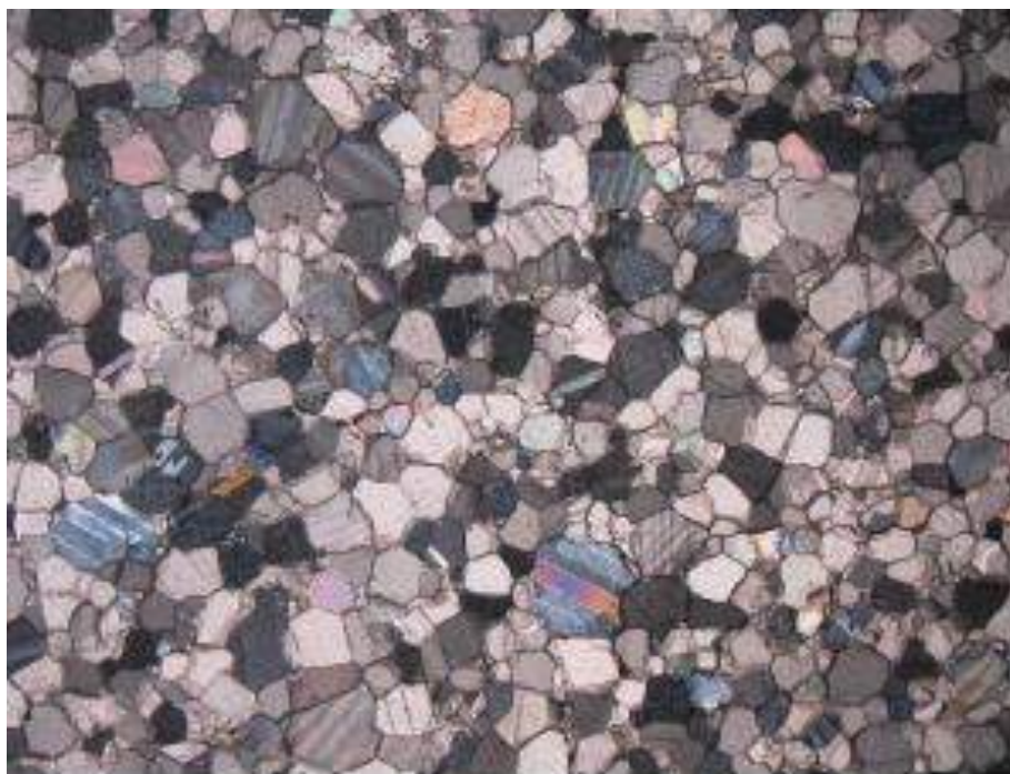
Figura 145. Vista microscópica de la muestra de mármol de la tumba de Ramón Castilla.
