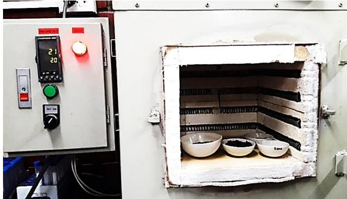
Figura 5.2. Puesta de material en el horno por 24 horas, a  $110^{\circ} \pm 5^{\circ}\text{C}$ .
