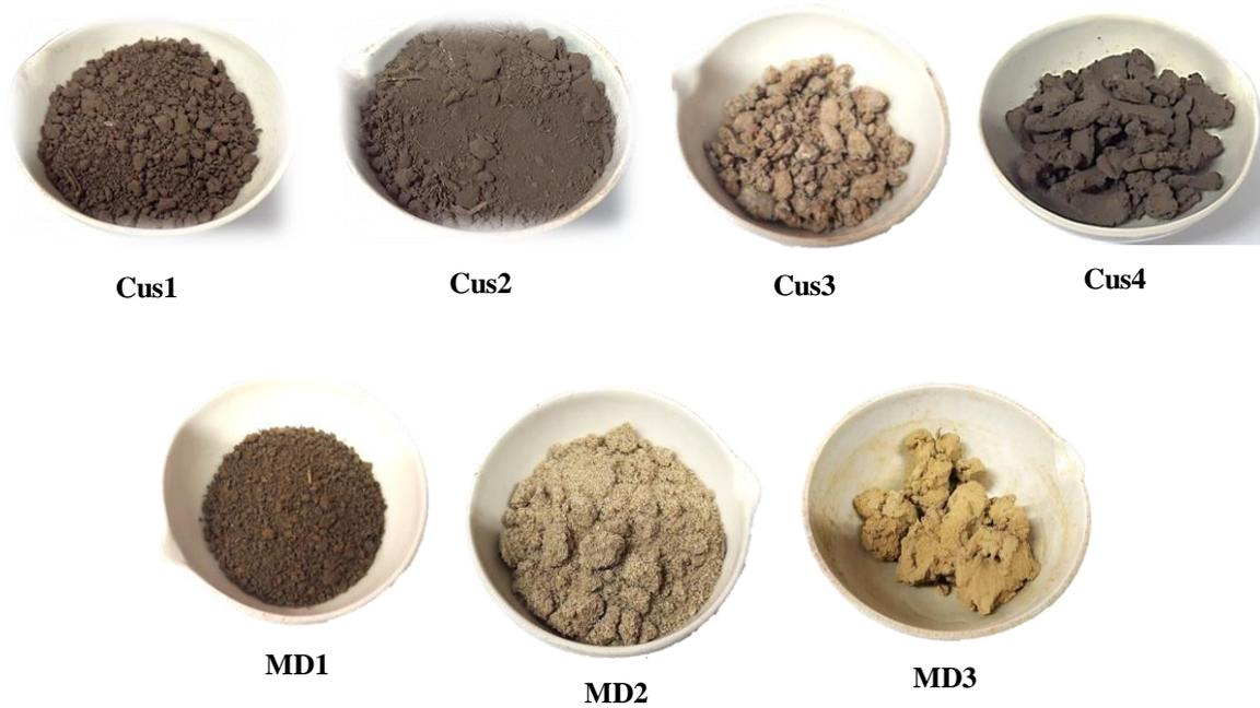
Figura 5.4. Muestras secadas durante 24 horas a una temperatura de  $110^{\circ} \pm 5^{\circ}C$ .
