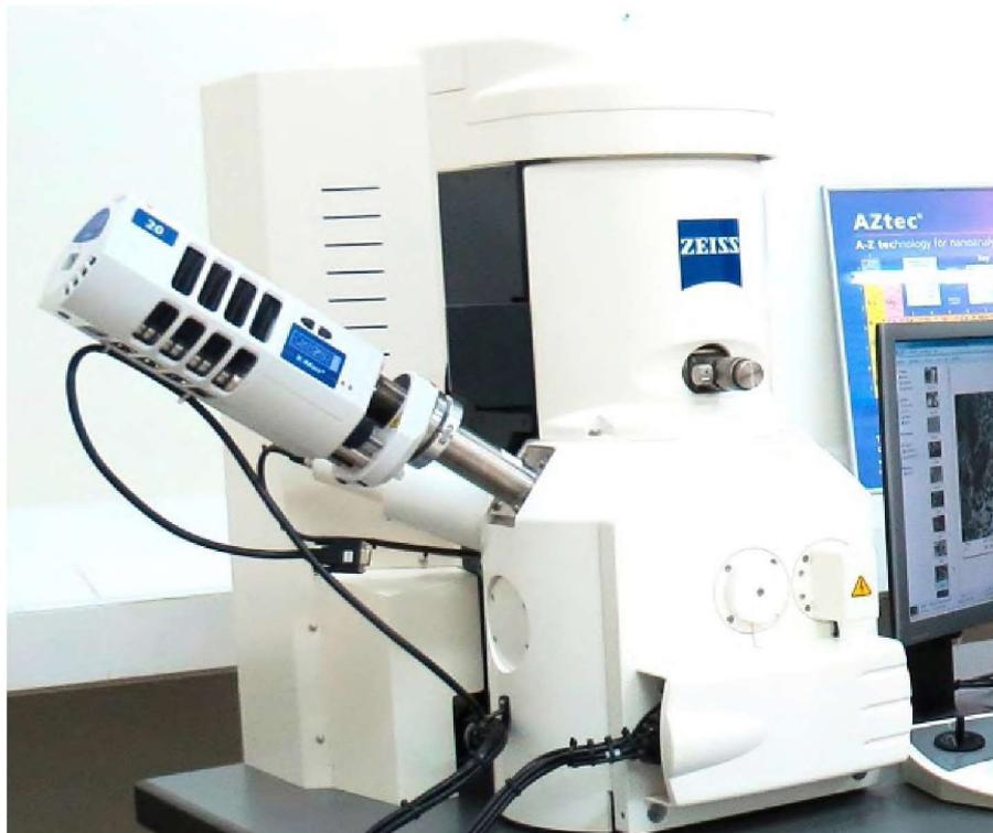
Figura 5.25: Detector EDS del acoplado en el microscopio electrónico de barrido.
