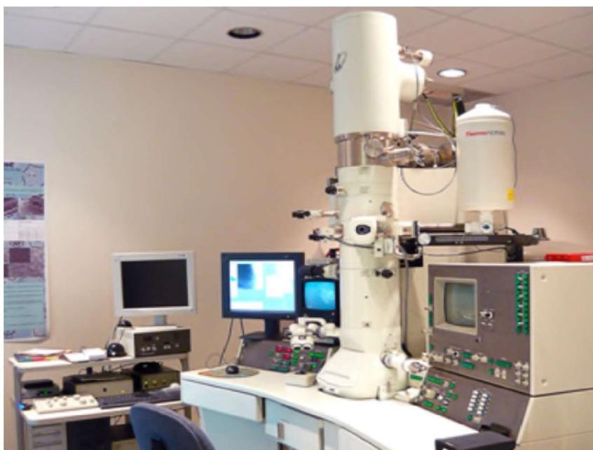
Figura 5.29: Microscopio electrónico de transmisión JEOL JEM-2010F.
