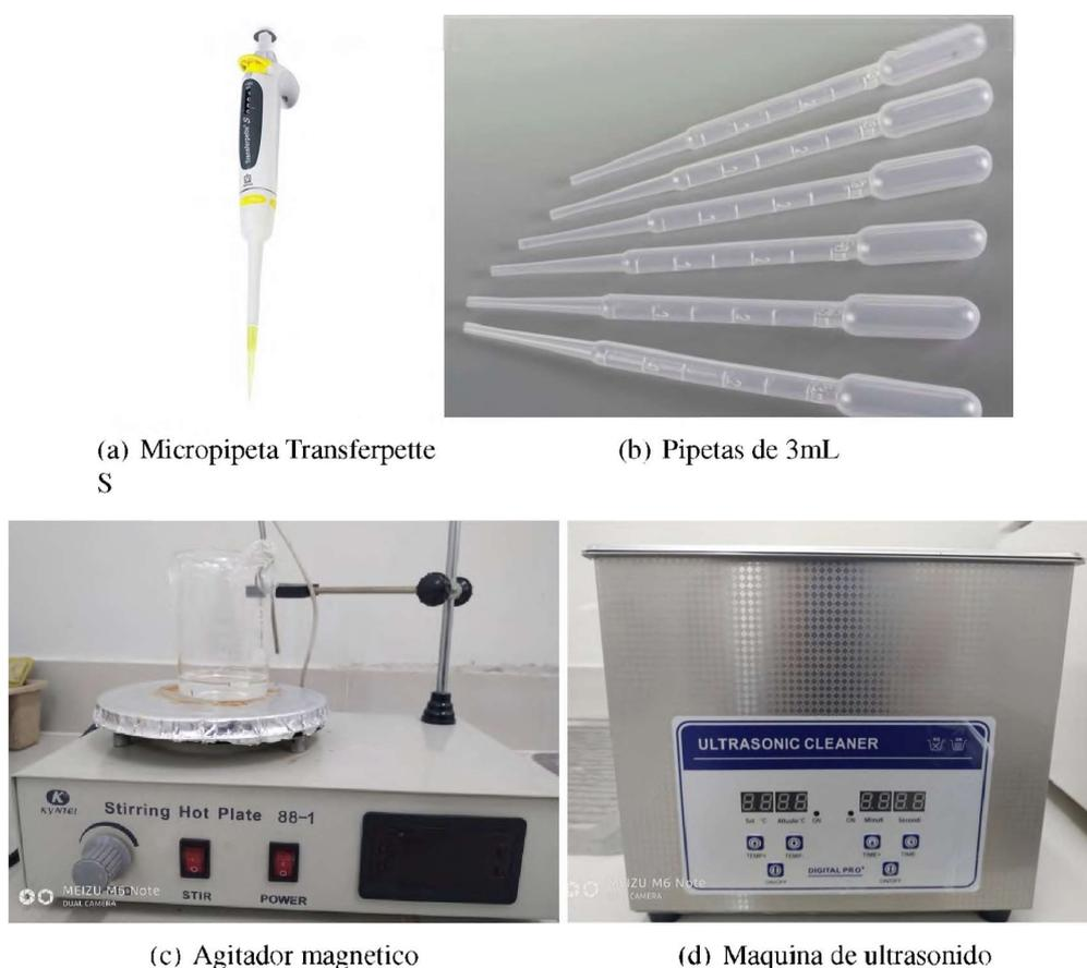
Figura 4.5: Equipos utilizados en el recubrimiento de las  $NaYF_4 : Yb/Ho$  con una capa de 10 nm de oxido de silicio.
