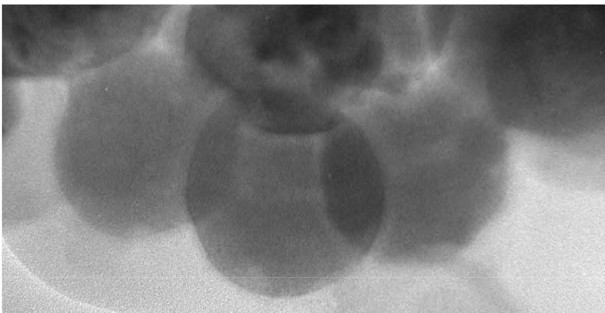
Figura 5.32: Imagen TEM de la **Muestra 3b** en donde se observa la morfología esférica de las nanopartículas.
