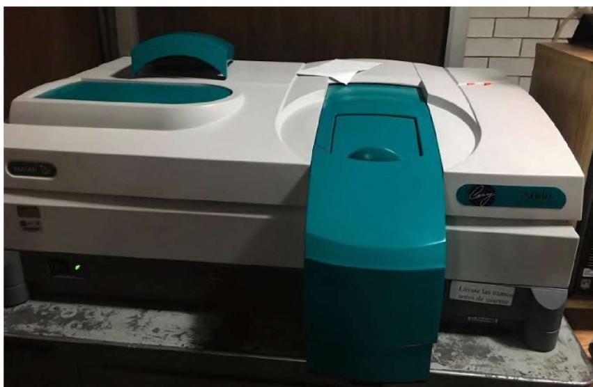
Figura 5.12: Espectrofotómetro Cary 5000, con el que se obtendrá los espectros de absorción de  $\text{NaYF}_4 : \text{Yb}/\text{Ho}$  a partir de una medida de reflectancia
