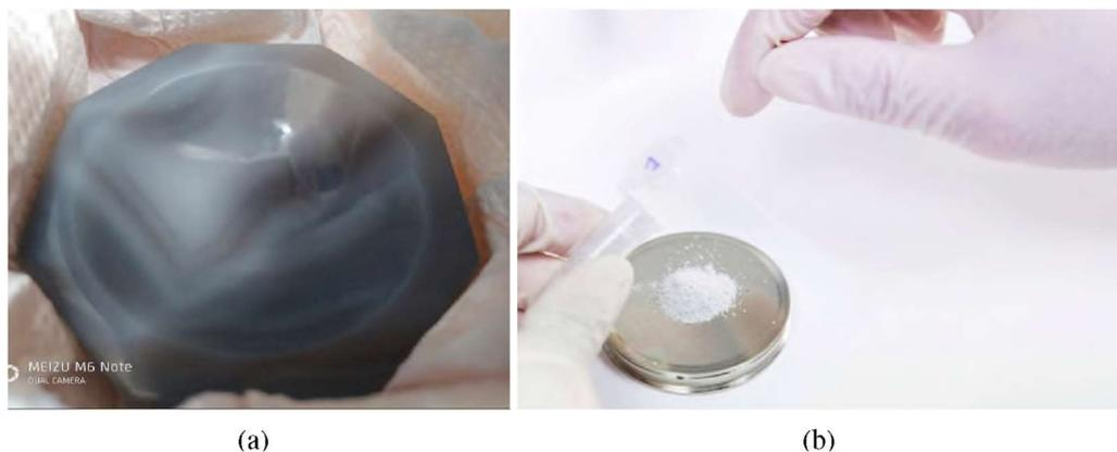
Figura 5.1: Equipamiento utilizado en la preparación de la muestra antes de ser colocado al difractor. **a)** Mortero de Ágata, utilizada para moler la muestra sin contaminarla. **b)** Portamuestras de fondo cero para que no produzca difracciones que no sean de la muestra.
