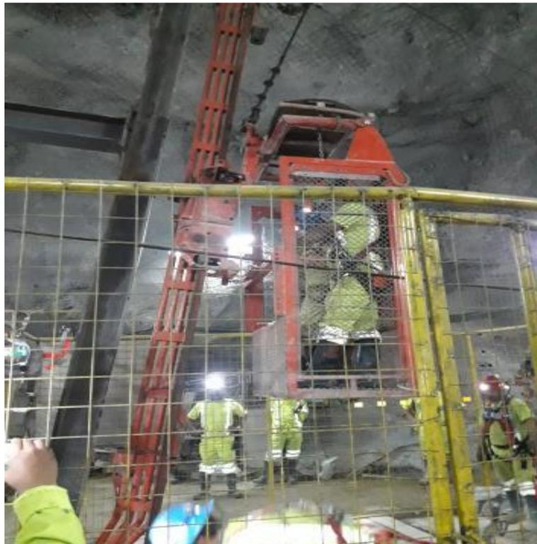
**Figura 3. 6** Prueba en Vacío con la Jaula Auxiliar
