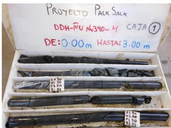
*Figura 4.55* Caja con testigos de perforación del clavo Ñusta
