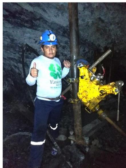
*Figura 4.56* Perforadora diamantina Pack Sack BBU2
