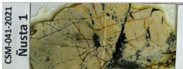
Figura 4.33 Sección doblemente pulida del clavo Ñusta, con texturas de relleno y reemplazamiento
