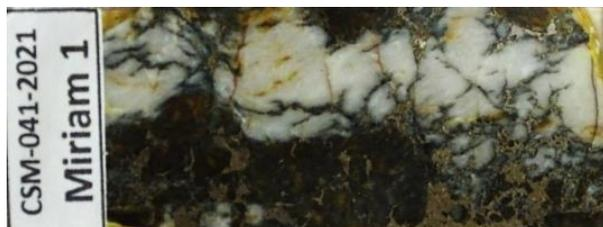
Figura 4.24 Sección doblemente pulida del clavo Miriam, con textura de relleno y reemplazamiento
