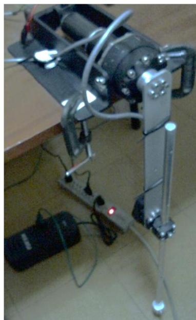
**Figura 4.7** Pruebas iniciales de ensamble del prototipo Pendubot.
