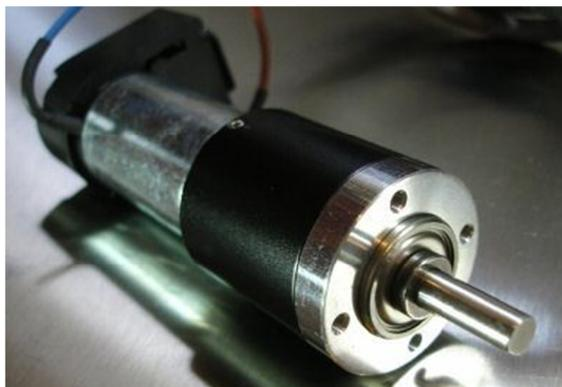
**Figura 4.10** Motor-reductor Maxon, actuador del eslabón 01.
