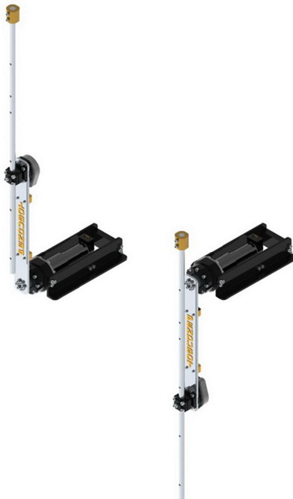
**Figura 2.4** Pendubot en la posición Superior (izquierda) e Inferior (derecha).
