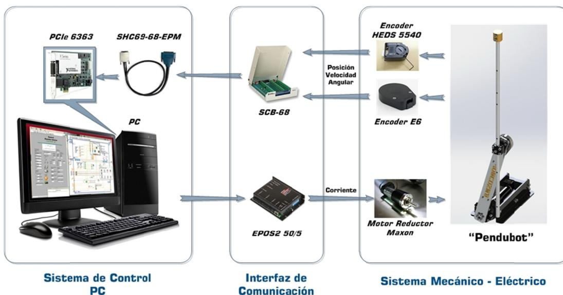
**Figura 4.8** Elementos del sistema mecatrónico Pendubot.
