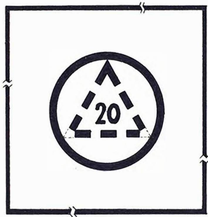
Circunscribir el triángulo de la señal de helipuerto en un círculo con línea llena de 60 cm. de ancho.
