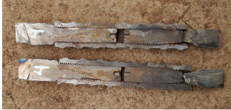
Figura 32. Perfil de falla del espécimen C-1
