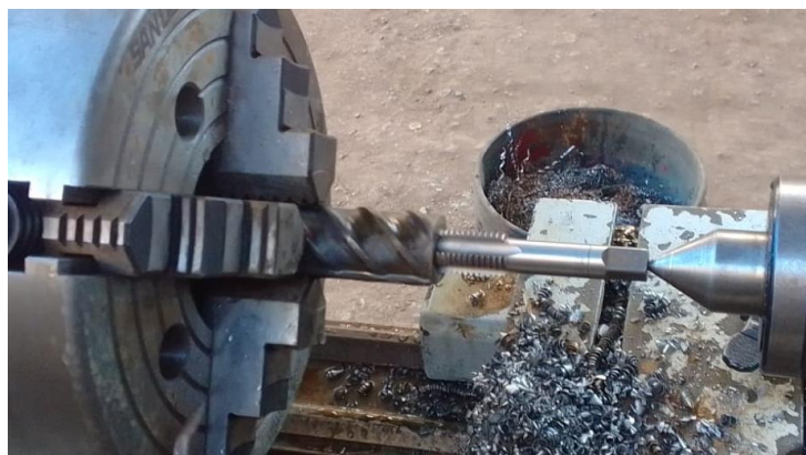
Figura 20. Perforación de varilla de diámetro nominal de 19.1mm
