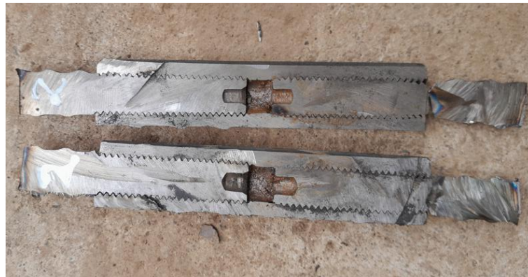
Figura 28. Perfil de falla del espécimen A-1
