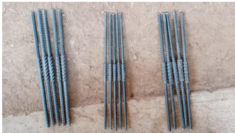
Figura 23. Especímenes de empalmes mecánicos
