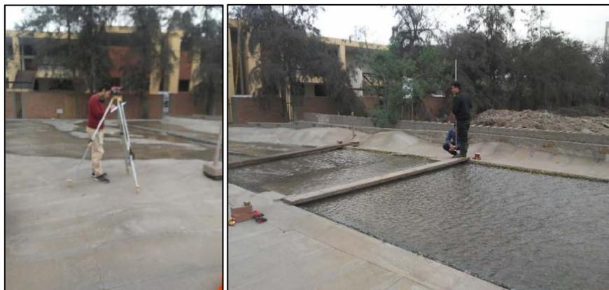
En el caso de los niveles de agua en los muros, se midió el nivel máximo alcanzado observándose que se producía una sobre elevación debido al choque del agua contra el muro, este efecto se ilustra en la Figura 3.8.
