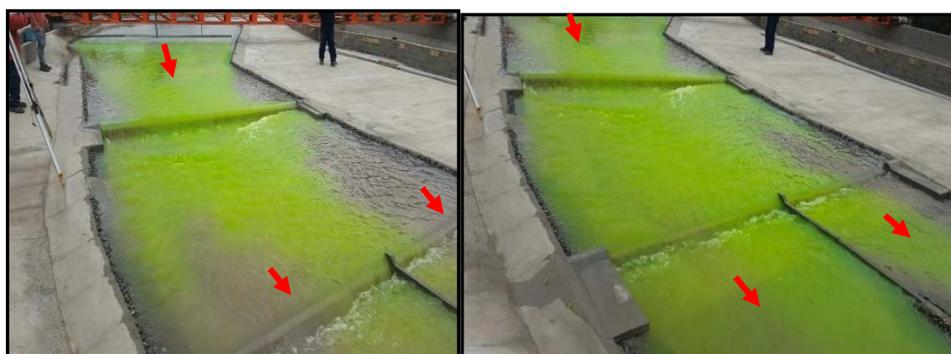
El resalto producido aguas abajo del barraje laminador no fue uniforme a lo ancho del cauce, debido a la irregular distribución del flujo ya mencionada. La mayor longitud del resalto fue de 51,20 m y se produjo a 60 m de la cara del muro del extremo derecho del barraje laminador. En la Foto 3.5 se muestra el resalto hidráulico en el primer diseño.
