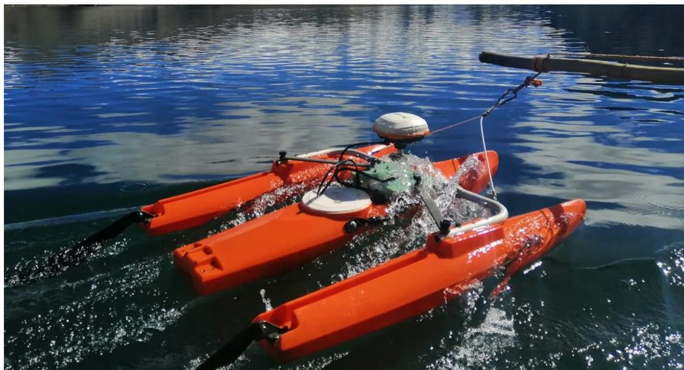
FIGURA N° 3.6: Soporte del ADCP. Elaboración propia
