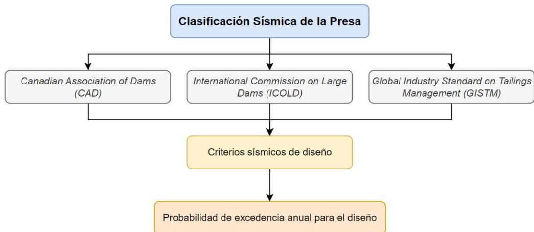
Figura 5.1 Diagrama de flujo de clasificación sísmica de la presa de relaves.
