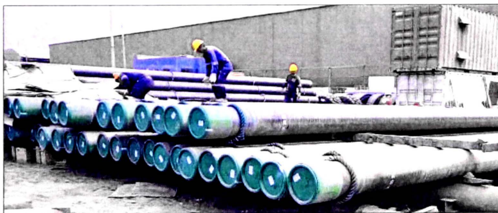
Figura 4. Tubería de Revestimiento (Casing)
