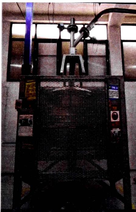
Figura 5.5 Tamizador y trampa magnética
