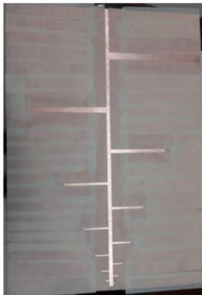
*Diseño de la antena LPDA cubierto con pintura negra.*
