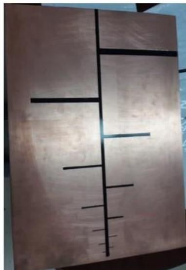
El cuarto paso en la fabricación consiste en la eliminación de cobre con ácido férrico que no pertenece al diseño de la antena LPDA. En la manipulación del ácido férrico se toman las medidas de protección usando guantes, mascarilla, bata de laboratorio, etc. La limpieza con ácido férrico consiste en sobar o refregar las partes de cobre que no están coloridas de pintura negra hasta la eliminación completa. Esta actividad tiene una duración de 6 horas.
