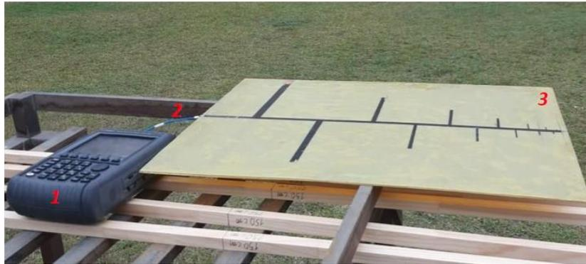
Los resultados experimentales y de simulación para el parámetro  $S_{11}$  se realizaron utilizando el VNA y el simulador Ansys HFSS para la antena DGS Vivaldi, respectivamente, como se muestran en la figura 27. La gráfica de pérdida de retorno empírica es similar a los resultados de simulación. En la frecuencia central, los resultados de la antena fabricada presentan mejor resultado en pérdida de retorno de -40 dB.
