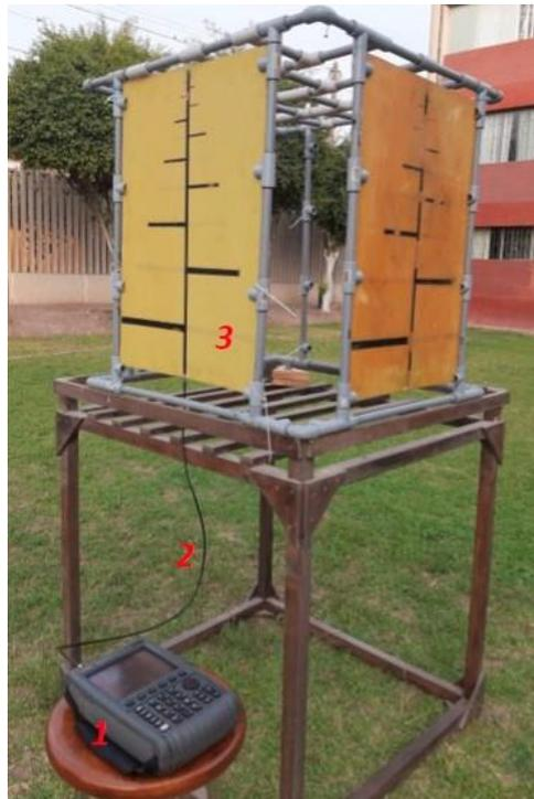
*Nota. Configuración experimental de caracterización de arreglo de LPDAs de doble polarización. (1) VNA, (2) cable SMA y (3) arreglo 2x2.*
