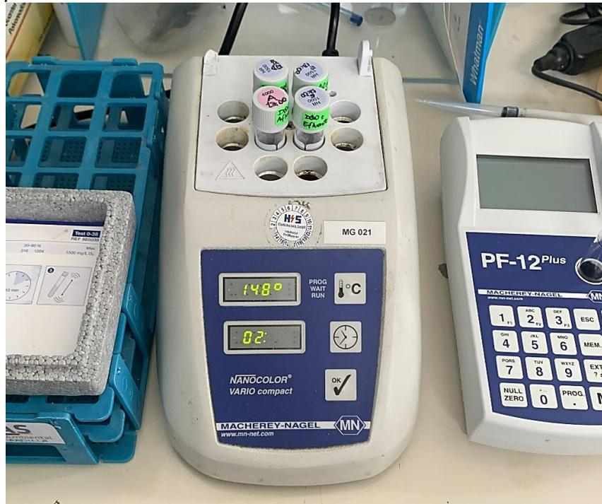
*Nota:* Se observa el digestor marca MN modelo Vario Compact para la medición de la DQO y DQO soluble, y el fotómetro marca MN modelo PF-12Plus.
