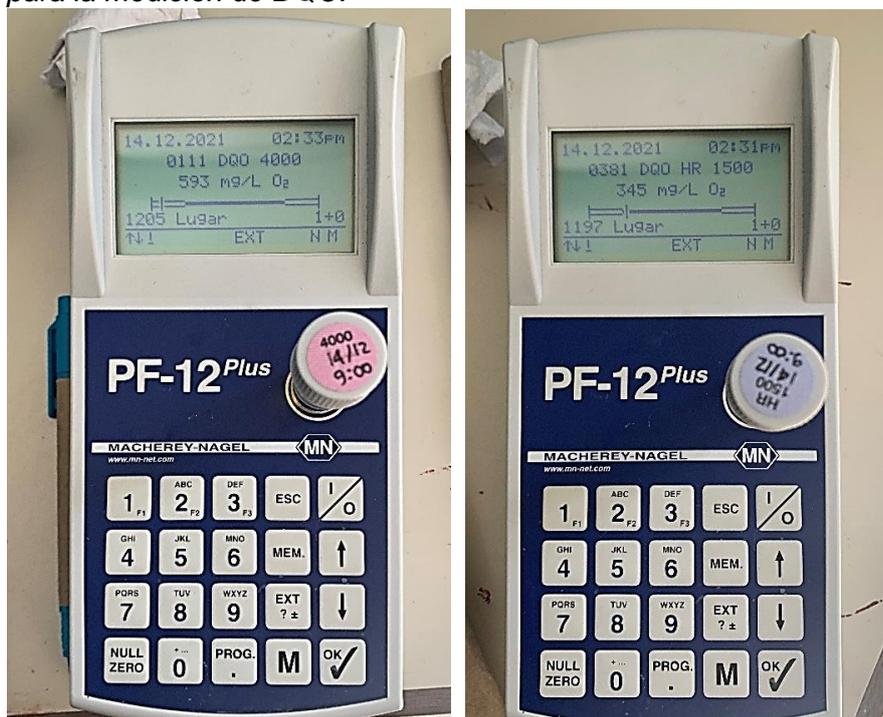
Nota: Se observa el fotómetro marca MN modelo PF-12Plus realizando la lectura de la medición de la DQO del día 14/12/2021. Los viales empleados para esta medición fueron de alto rango (high range) con un límite de medida en la mayoría de los casos hasta los 1500 mg/L, y en algunos casos se usó viales hasta los 4000 mg/L.
