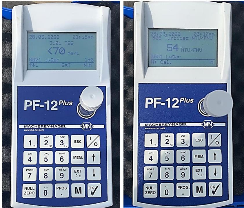
*Nota:* Fotómetro portátil realizando las mediciones de turbiedad y sólidos suspendidos totales en el día 28/03/2022 mediante el método fotométrico.
