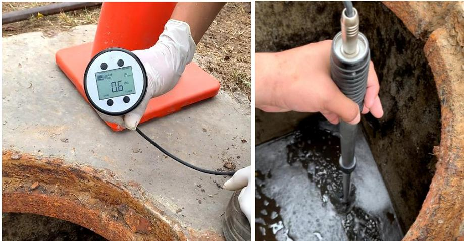
*Nota: Medición del tirante con regla (izquierda) y medición de velocidad con correntómetro digital (derecha).*
