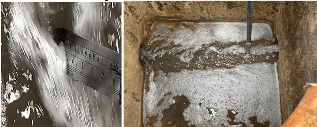
*Nota: Medición del tirante de agua con una regla metálica.*
