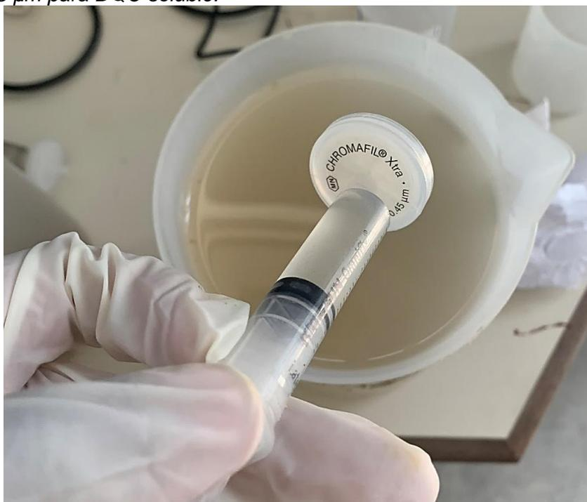
Nota: Filtro de jeringa de 0.45  $\mu\text{m}$  marca MN modelo Chromafil Xtra para la filtración de muestras para la medición de DQO soluble. El interior del filtro de jeringa contiene una membrana hidrofóbica de PTFE (politetrafluoroetileno) que es muy resistente a todo tipo de disolventes, así como a ácidos y bases.
