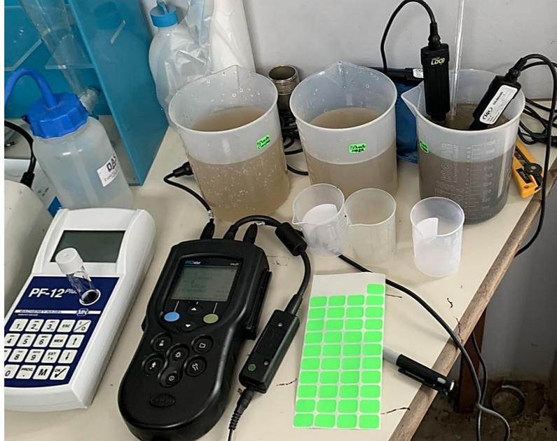
*Nota:* Equipos usados en las mediciones rutinarias durante la investigación, se observa el fotómetro portátil marca MN modelo PF-12Plus, el multiparámetro marca Hach modelo HQ40d, los sensores de pH y de oxígeno disuelto y los vasos precipitados de plástico de 1000 ml y 100 ml.
