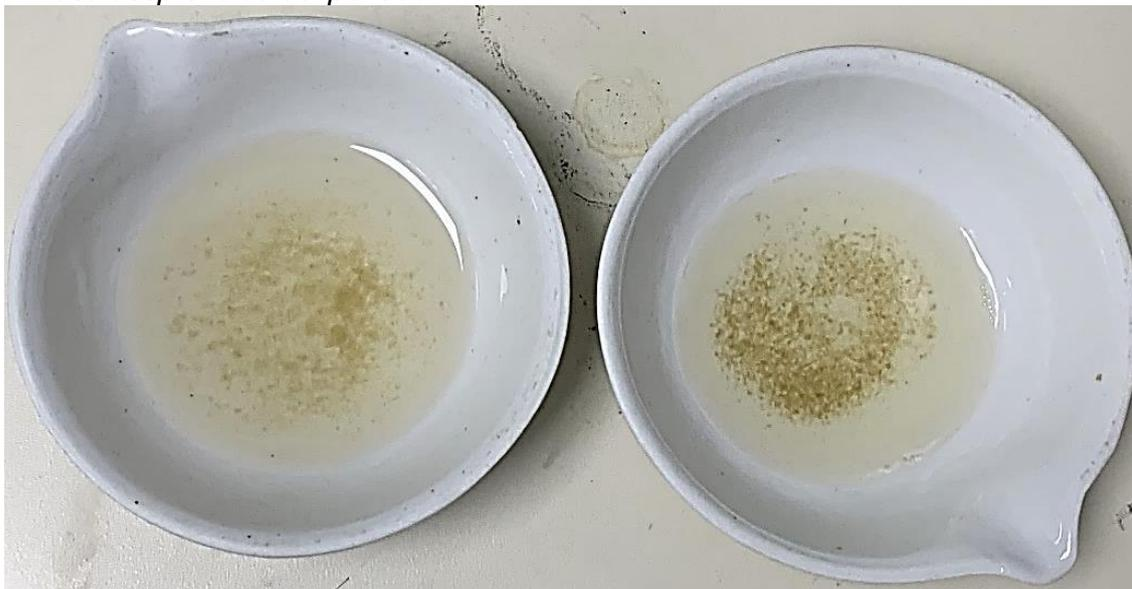
*Nota:* Mezcla líquido-sólido resultante con la biomasa desprendida del portador mediante la metodología hidróxido de sodio.
