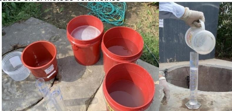
*Nota:* Recipientes (izquierda) y probeta graduada de 1000 ml (derecha) para medir el volumen almacenado.
