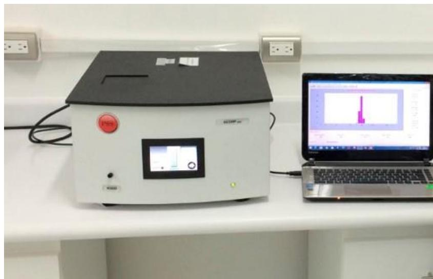
**Imagen 7.** Equipo de absorción atómica de flama modelo contrAA 800-D Analytik Jena AG con lámpara de arco de xenón de espectro continuo del Laboratorio de Investigación y Química Aplicada de la Facultad de Ingeniería Química y Textil de la Universidad Nacional de Ingeniería
