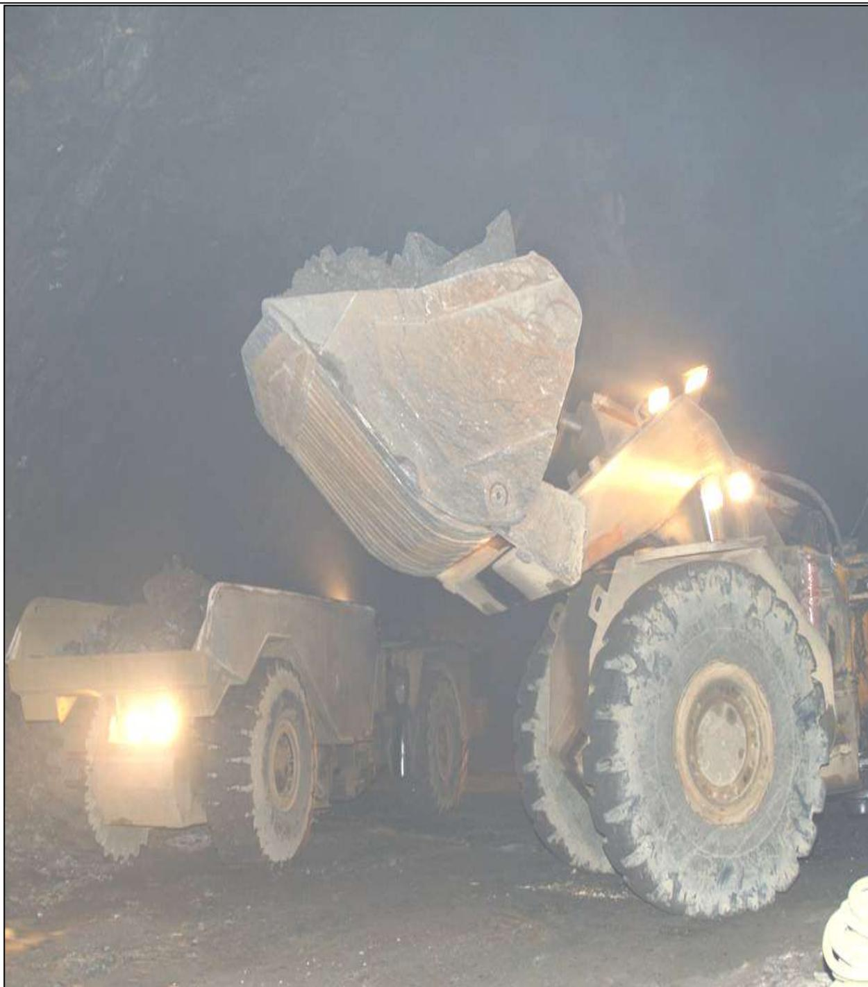
**Equipo de carguío en espera de posicionamiento del damper para su llenado**
