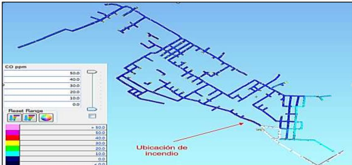
**Figura 4.41** Vista en Planta Nv 1650 Después de 7 Horas de Incendio
