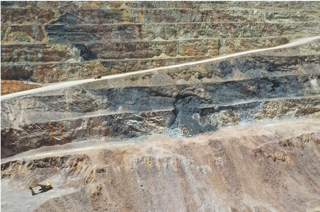
Fuente: Mina La Arena (2021). Presencia de carbon en taludes de una mina Superficial. Elaboración propia.
