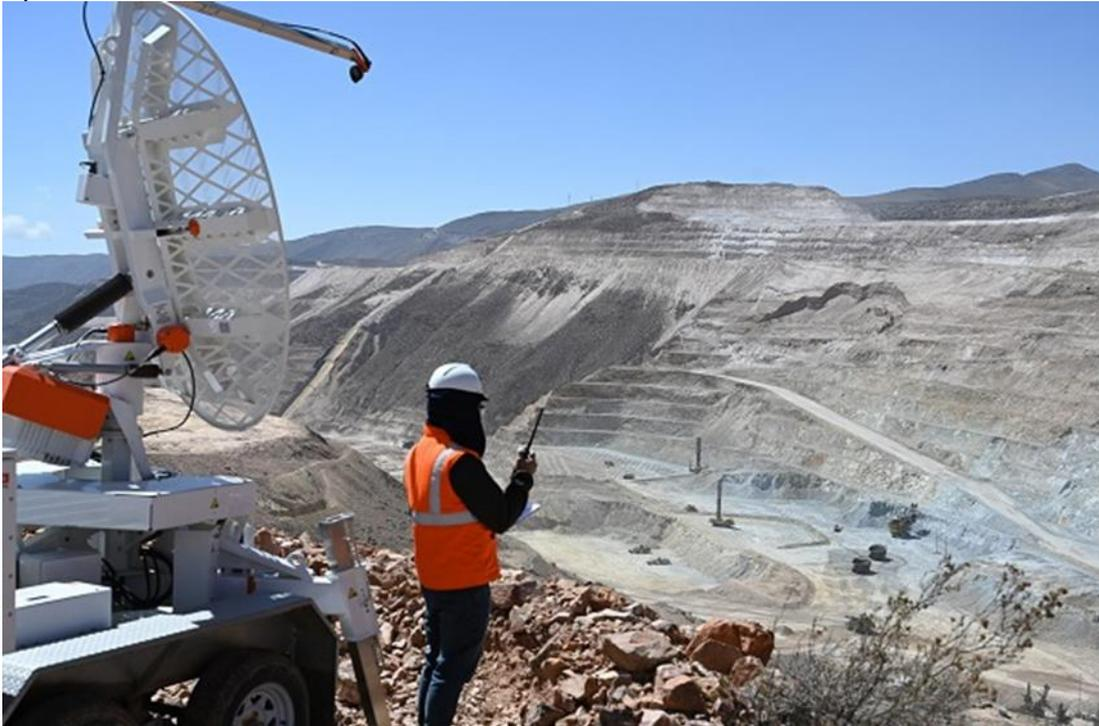
Fuente: América Minera (2022). Perú: Quellaveco usa radares, imágenes satelitales y estación robotizada para monitorear estabilidad de taludes. Tomado de: <https://americaminera.com/peru-quellaveco-usa-radares-imagenes-satelitales-y-estacion-robotizada-para-monitorear-estabilidad-de-taludes/>
