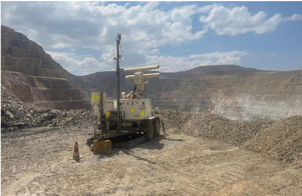
Fuente: Mina La Arena (2023). Monitoreo de estabilidad de taludes con radar geotécnico.
