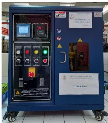
*Nota.* La capacidad de carga de la máquina es 24 tubos de acero inoxidable de 500 mL, con rango de temperatura de 20-140°C y microprocesador para su control.
