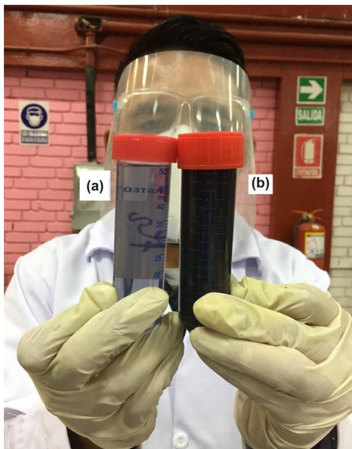
*Nota:* (a) baño residual de la muestra teñida y previamente cationizada y (b) baño residual de la muestra teñida convencionalmente.
