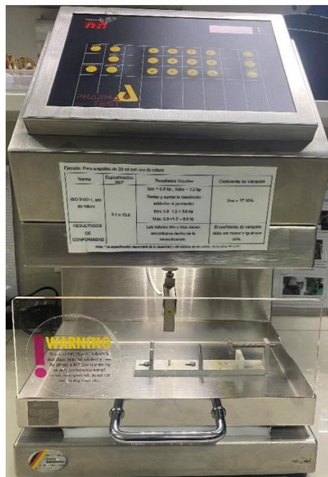
El procedimiento para la ruptura, es establecer la distancia entre las dos barras de metal, de modo que se repose la ampolla de forma horizontal la ampolla, tal que la cuña impacte en el medio de las barras formando un ángulo de 90 °C con la ampolla y rompa justo en la zona de estrangulamiento, con este procedimiento la maquina registrar la fuerza de ruptura.
