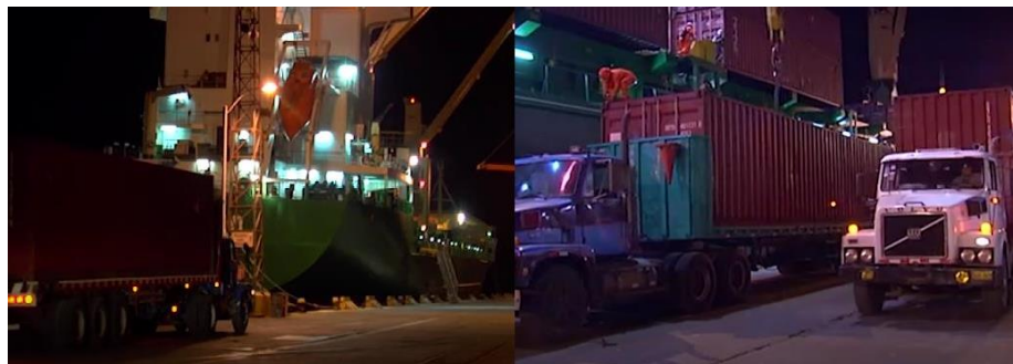
Figura N°3.27 Embarque de carga contenedorizada bajo la modalidad directa Fuente: Terminal portuario de Chimbote G.R.
