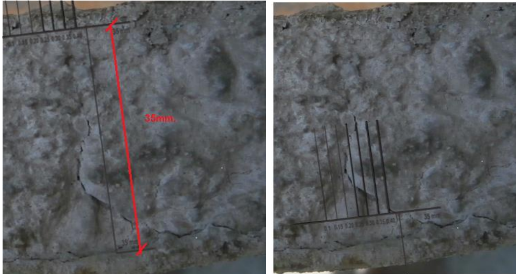
FOTO 2.9 y 2.10 Uso del fisurómetro de computadora para las medidas finales de fisuras
