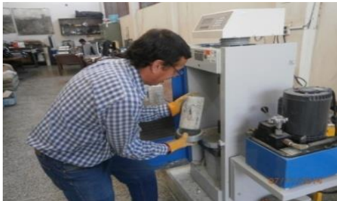
FOTO 4.16 Prueba de rotura
