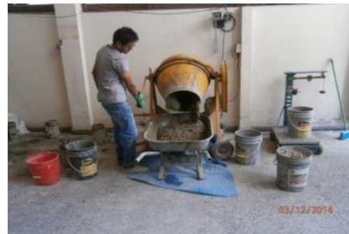
FOTO 4.2. Vaciado de la mezcla
