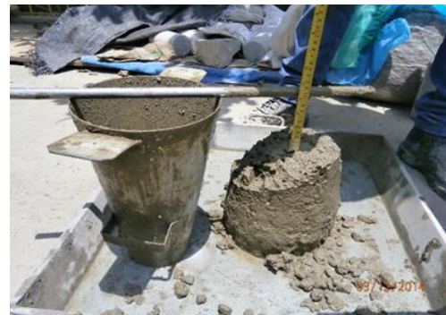
FOTO 4.5. Medida del Slump
