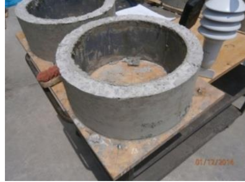
FOTO 5.6 Poca presencia de vacíos lateral
