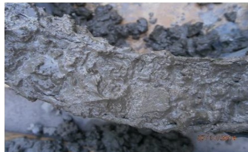
FOTO 5.2 Acabado slump bajo
