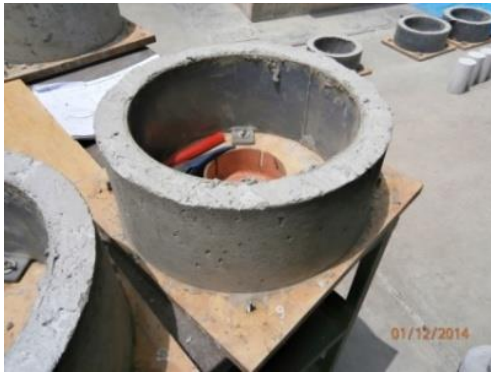
FOTO 5.1 Compactación, no se consigue
