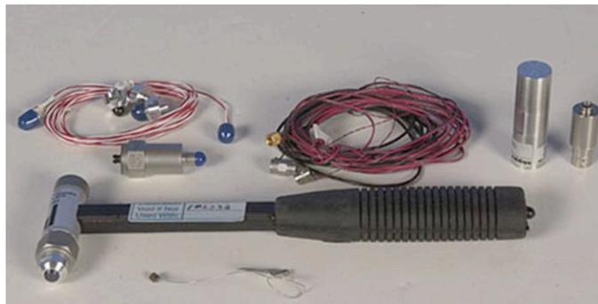
Figura 2.15 Martillo de impulso y acelerómetro
