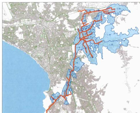
Figura 3.10 Colector Circunvalación y sus respectivas subáreas de drenaje
