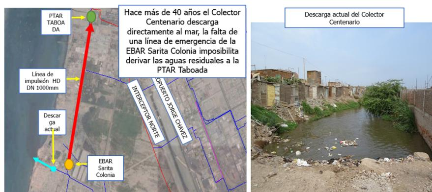
Figura 3.29 Problemas de descarga del colector Centenario
