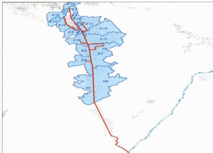
Figura 3.16 Colector Manchay y sus respectivas subáreas de drenaje
