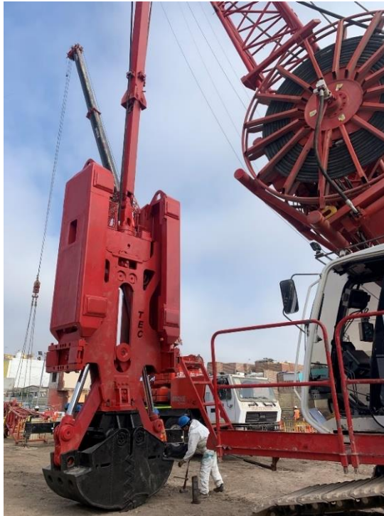
Figura N°2.7 Almeja hidráulica guiada con Kelly. Fuente: Elaboración propia.
