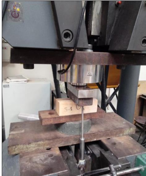
Figura N° 13. Ensayo de compresión perpendicular al grano
