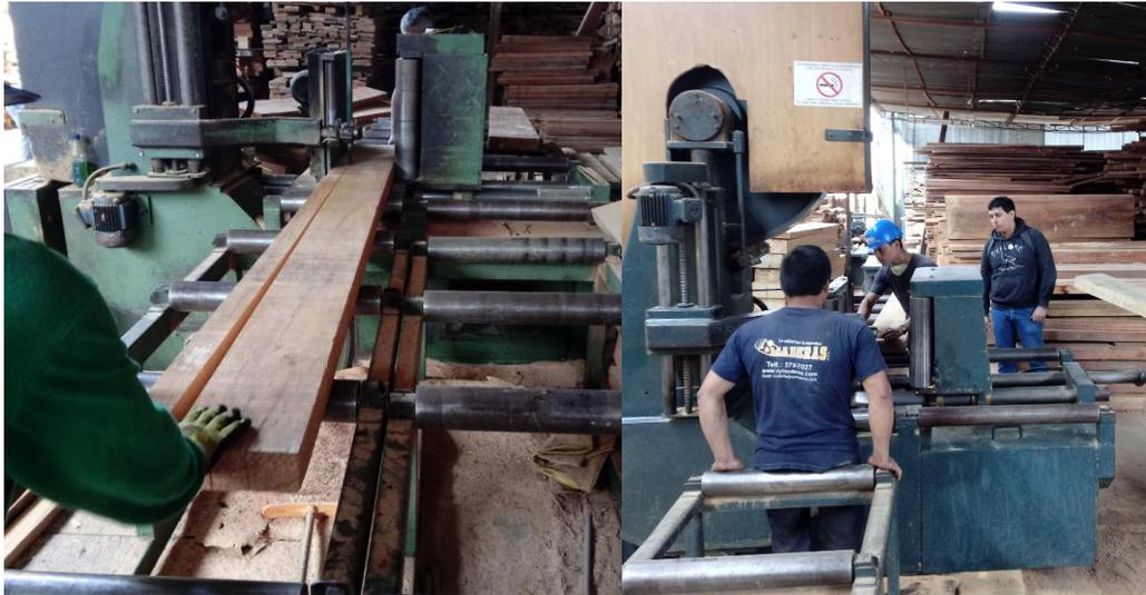
Figura N° 16. Proceso de corte de la madera aserrada.
