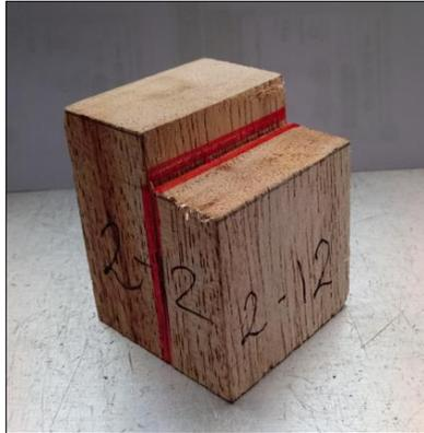
Figura N° 10. Probeta de corte paralelo al grano.
