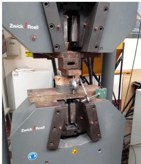
Figura N° 31. Ensayo de Compresión Perpendicular al Grano
