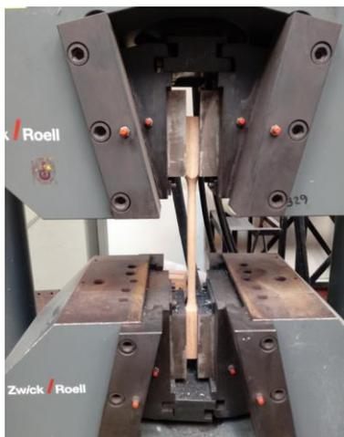
Figura N° 40. Ensayo de Tracción paralela a las fibras.
