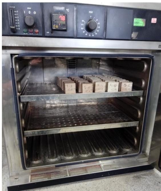
Figura N° 23. Muestras de probeta en el horno para hallar el contenido de humedad del ensayo de Compresión Paralela al Grano
