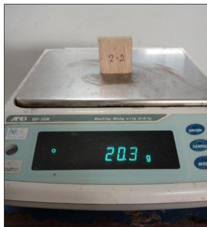
Figura N° 9. Balanza de precisión.
