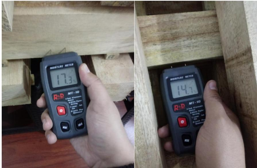
Figura N° 18. Medida de contenido de humedad
