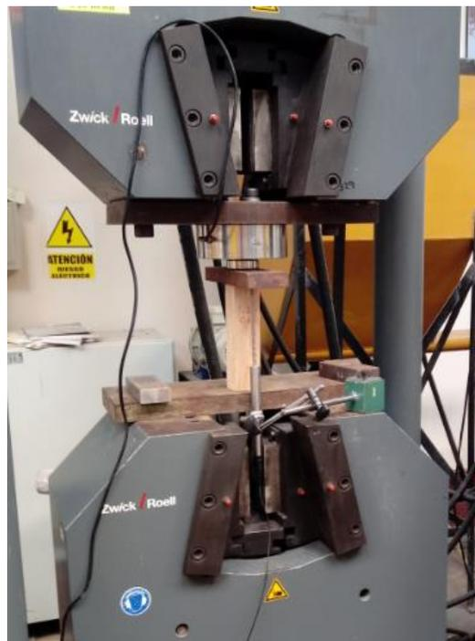
Figura N° 22. Ensayo de Compresión Paralela al Grano
