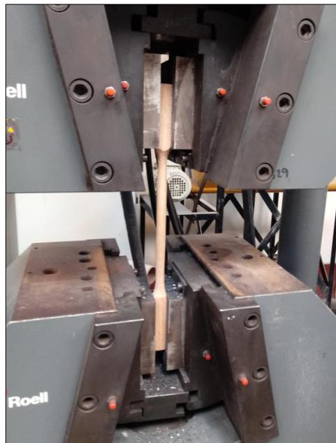
Figura N° 14. Ensayo de tracción paralela a las fibras
