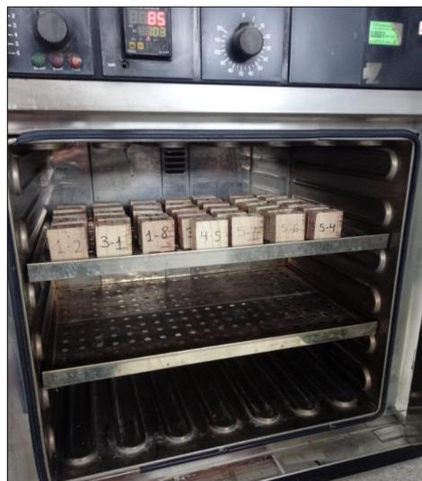
Figura N° 32. Muestras de probeta en el horno para hallar el contenido de humedad del ensayo de Compresión perpendicular al grano.
