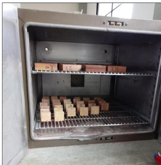
Figura N° 50. Muestras de probeta en el horno para hallar el contenido de humedad del ensayo de Corte paralelo al grano.
