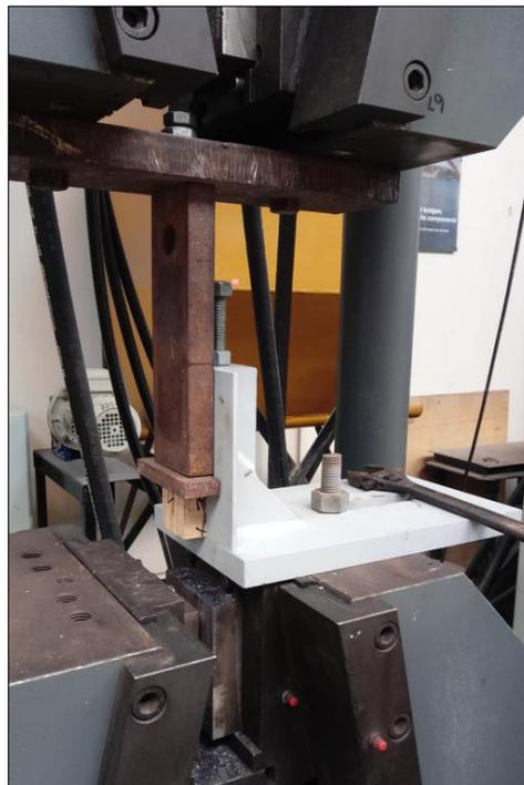
Figura N° 11. Ensayo de corte paralelo al grano.
