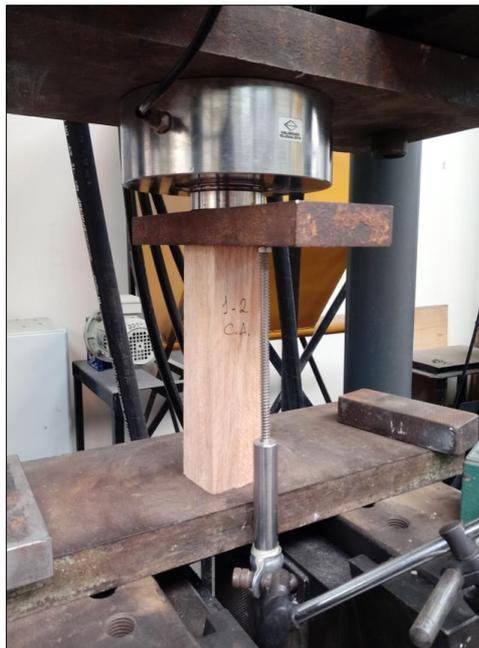
Figura N° 12. Ensayo de compresión axial
