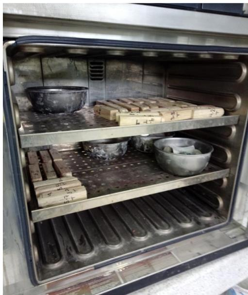
Figura N° 41. Muestras de probeta en el horno para hallar el contenido de humedad del ensayo de Tracción paralela a las fibras.
