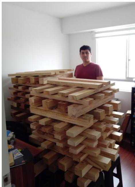
Figura N° 17. Apilamiento de la madera Pashaco.
