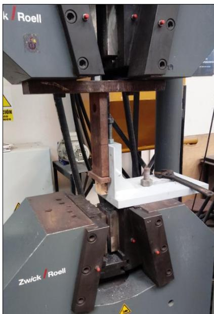
Figura N° 49. Ensayo de Corte paralelo al grano.
