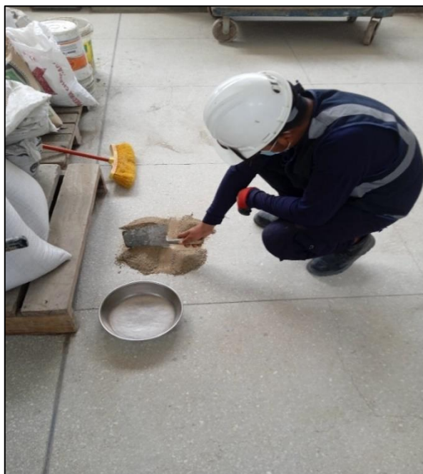
Figura A.02: Cuarteo para ensayos y obtener propiedades del agregado fino.
