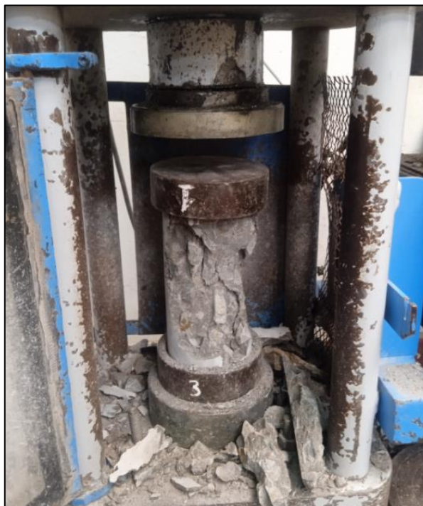
Figura A.12: Ensayos de resistencia a la compresión axial para cada diseño de concreto.
