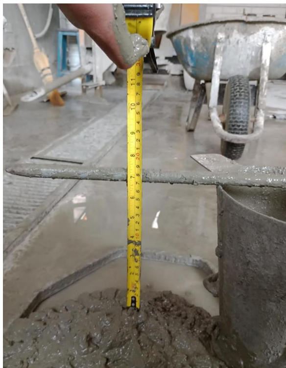
Figura A.07: Ensayo de consistencia de las muestras de concreto.
