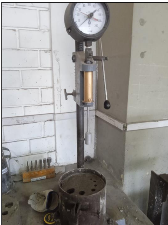
Figura A.11: Ensayo de tiempo de fragua mediante las agujas de Vicat para cada diseño de concreto.
