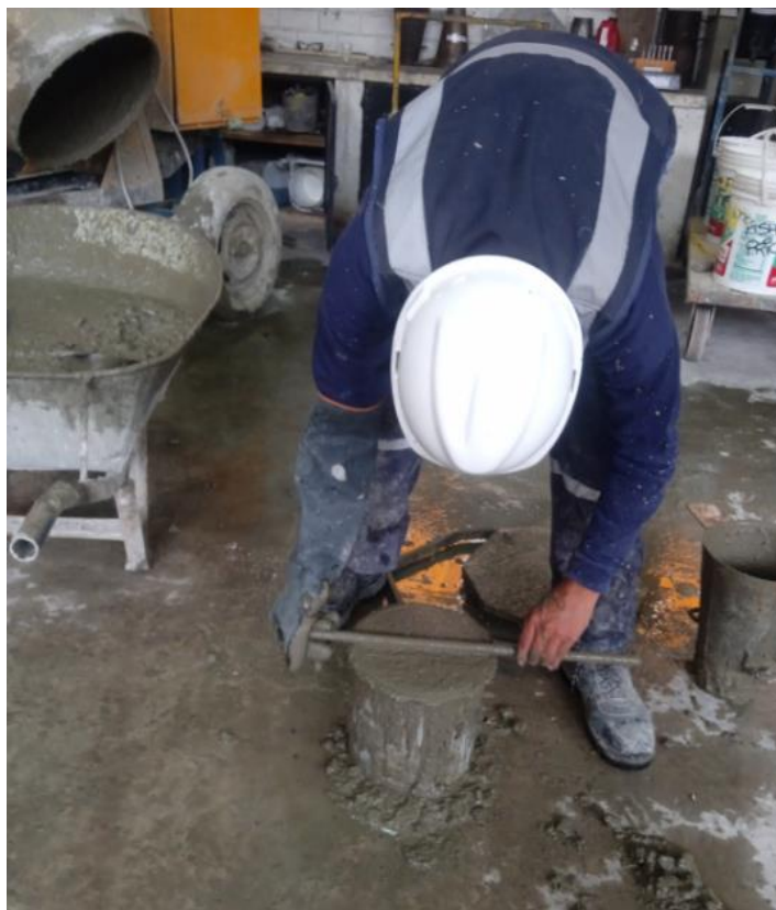
Figura A.08: Ensayo de peso unitario de las muestras del concreto.
