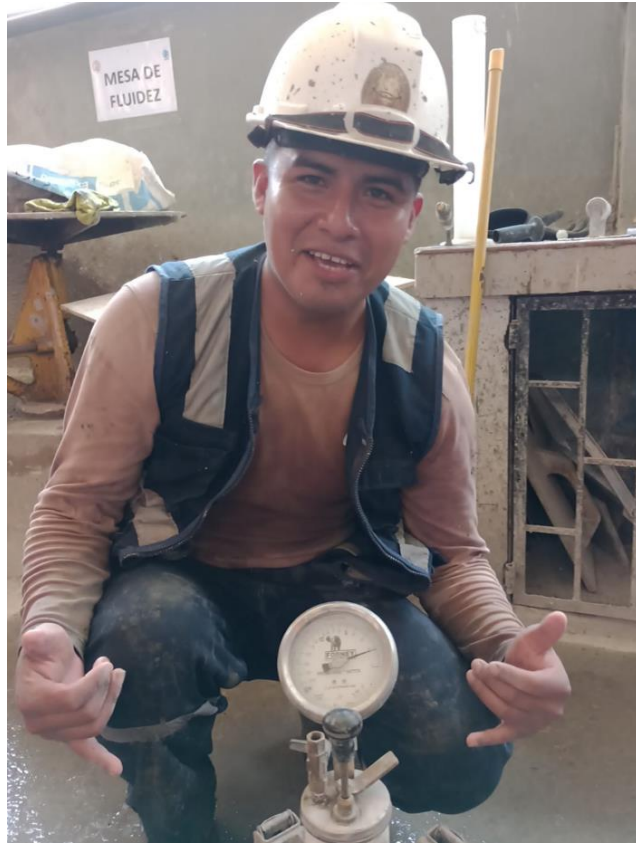
Figura A.09: Ensayo de contenido de aire mediante la olla de Washington de la muestra de concreto.
