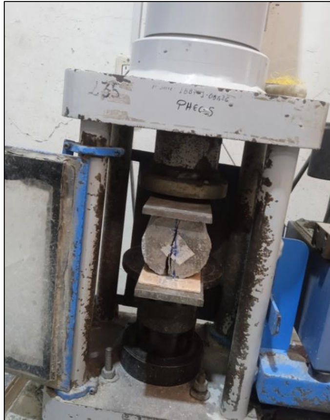
Figura A.13: Ensayos de resistencia a la tracción diametral para cada diseño de concreto.
