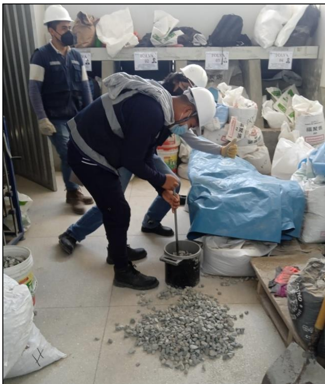
Figura A.05: Ensayos de peso unitario suelto y compactado del agregado grueso.
