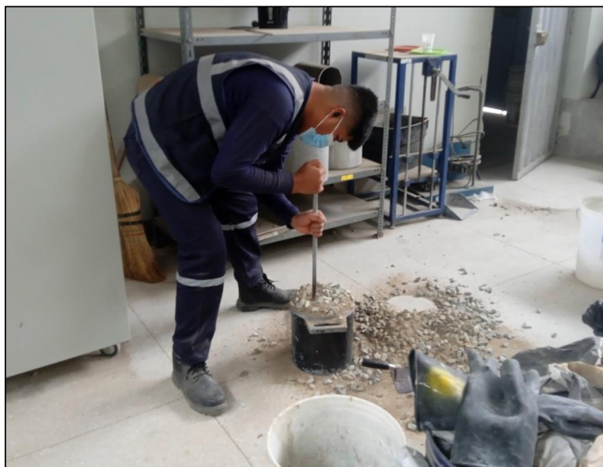
Figura A.06: Ensayos de peso unitario compactado del agregado global.
