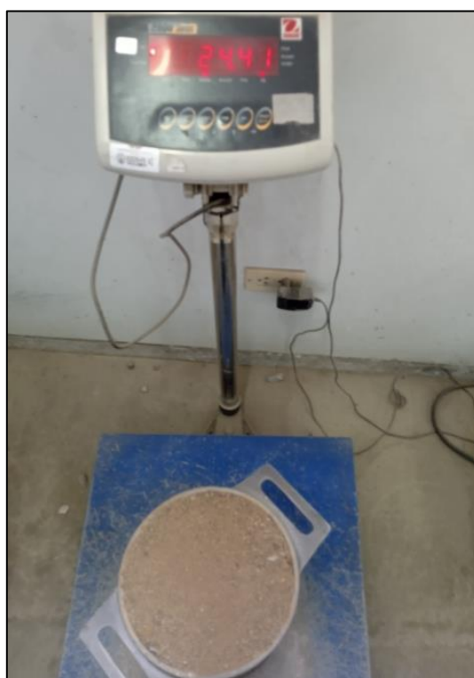
Figura A.04: Ensayos de peso unitario suelto y compactado del agregado fino.
