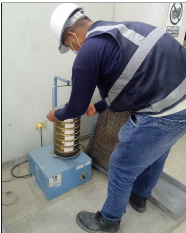
Figura A.01: Ensayo de granulometría de agregados.
