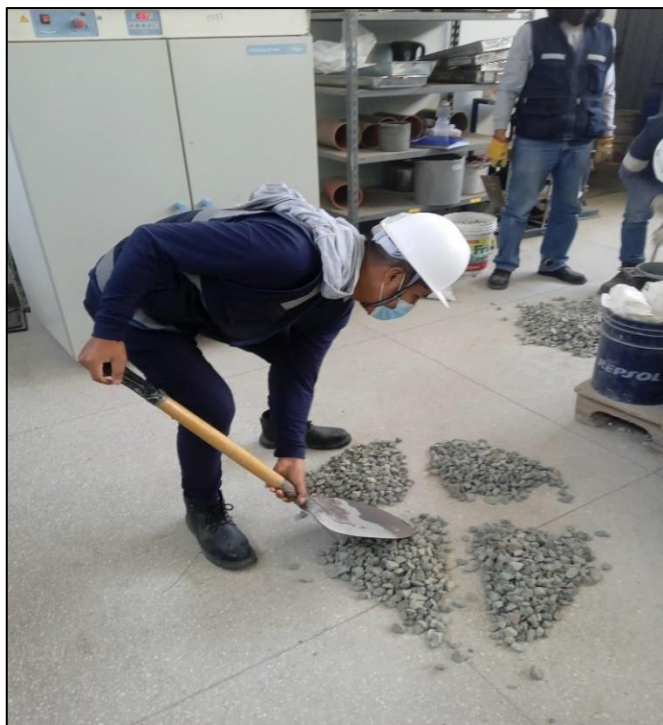
Figura A.03: Cuarteo para ensayos y obtener propiedades del agregado grueso.
