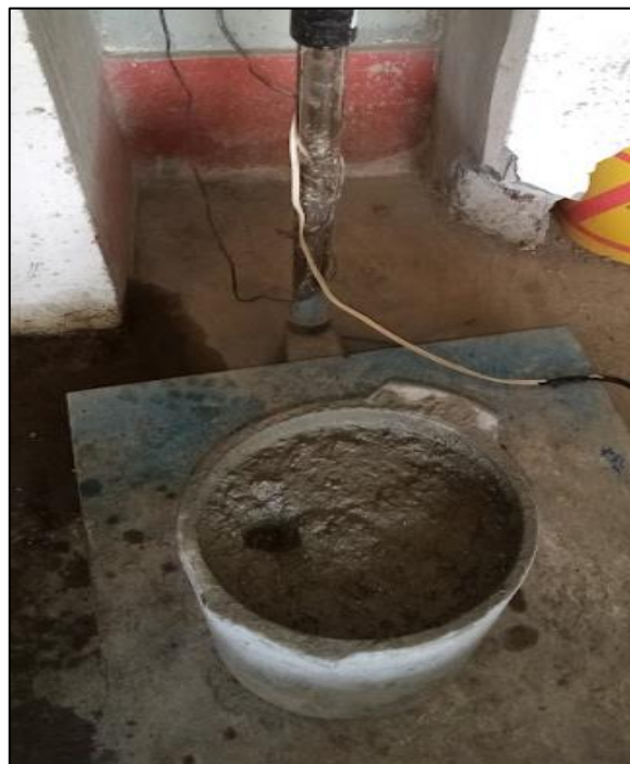
Figura A.10: Ensayo Exudación para cada diseño de concreto.
