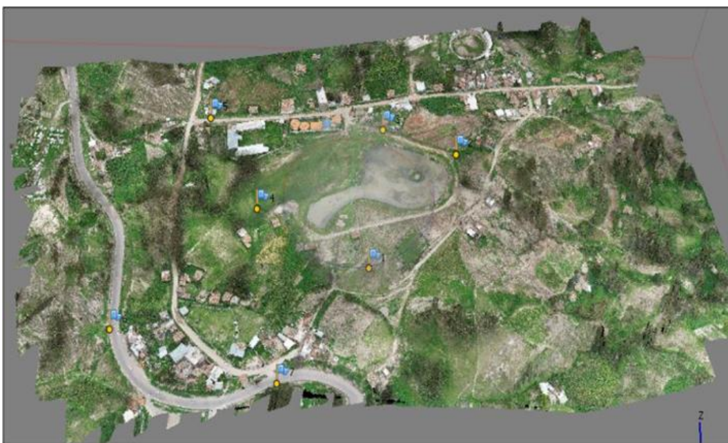
Levantamiento en 3D generado por fotogrametría
