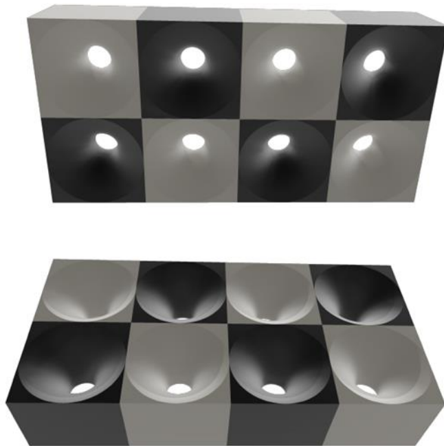
Figura 1. Celdas Eólicas configurando un Muro Eólico.
