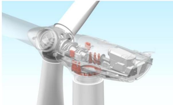
**Sistema de lubricación:** sistema que controla la recirculación del aceite en la multiplicadora.
