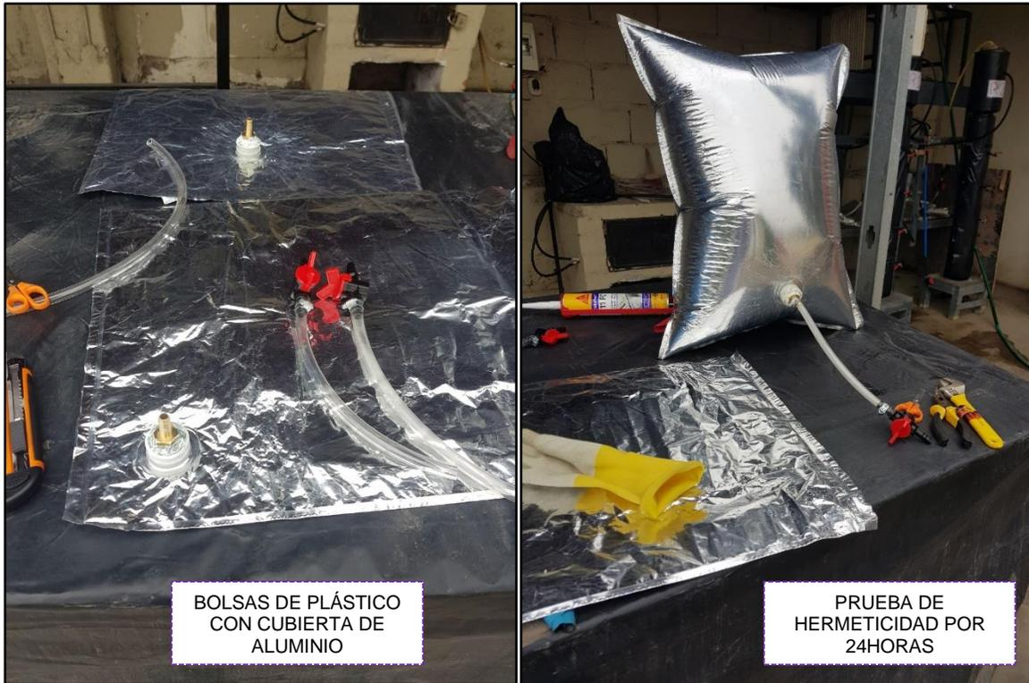
*Imagen 9. Ensamblaje de sistema de almacenamiento de Biogás.*
