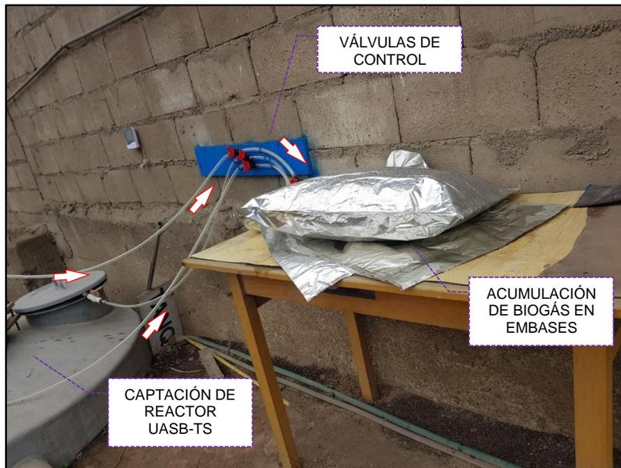
**Imagen 10.** Sistema de lavado de Biogas, para eliminación del CO<sub>2</sub>.
