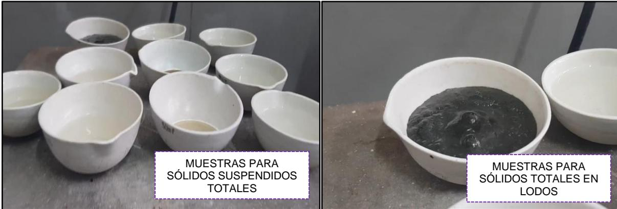
**Imagen 12.** Llevado a Horno para determinación de sólidos totales y Muffla para determinación de sólidos fijos y volátiles
