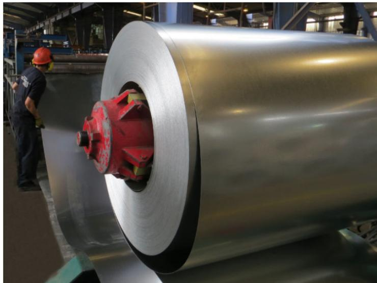
FIGURA N° 2.17: Fabricación de placas colaborantes a partir de bobinas de acero.
