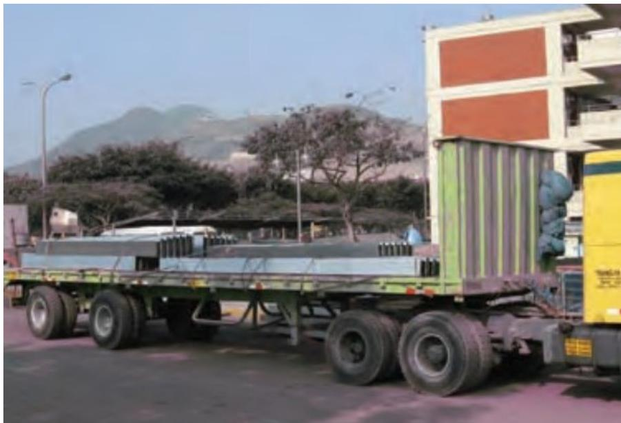
FIGURA N° 3.27: Disposición de placas en su transporte a obra.
