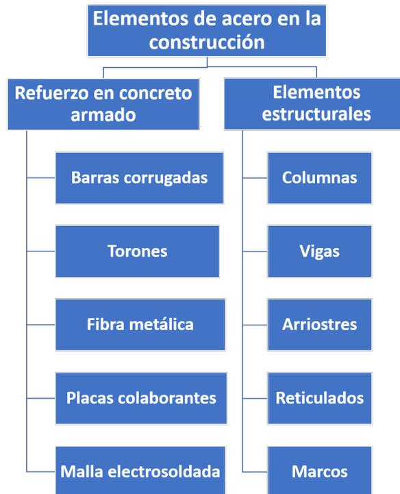
FIGURA N° 2.8: Uso del acero en la construcción. Elaboración propia
