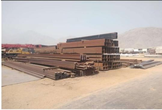
(a) Columnas y vigas metálicas en el taller antes del proceso de fabricación.
