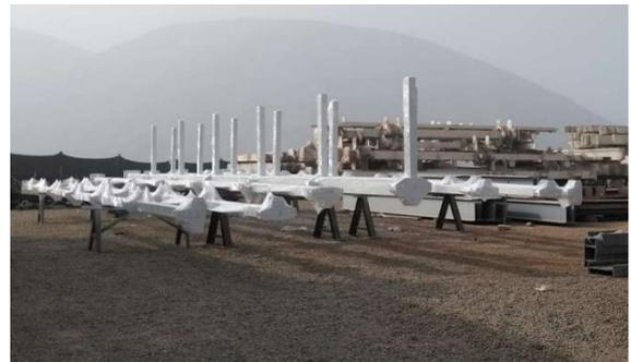
(b) Columnas metálicas fabricadas.
