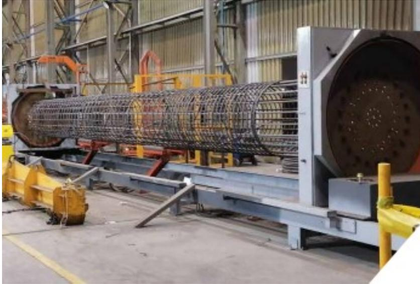
FIGURA N° 3.12: Fabricación de la armadura prearmada de una columna.
