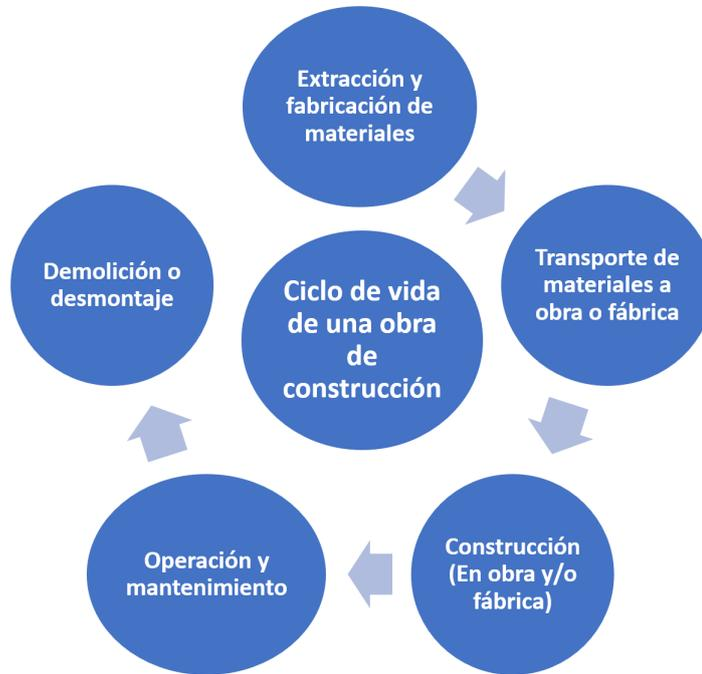
FIGURA N° 2.7: Ciclo de vida de una obra de construcción. Adaptado de Chang (2014)
