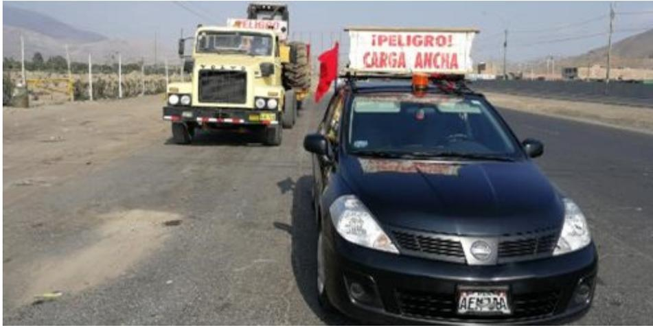
FIGURA N° 3.19: Ejemplo de escolta para transporte de carga ancha.
