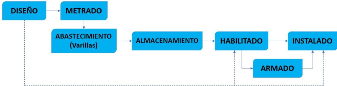
FIGURA N° 3.7: Proceso tradicional de colocación de acero de refuerzo.
