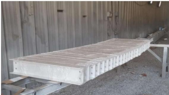
(a) Vigas metálicas fabricadas.
