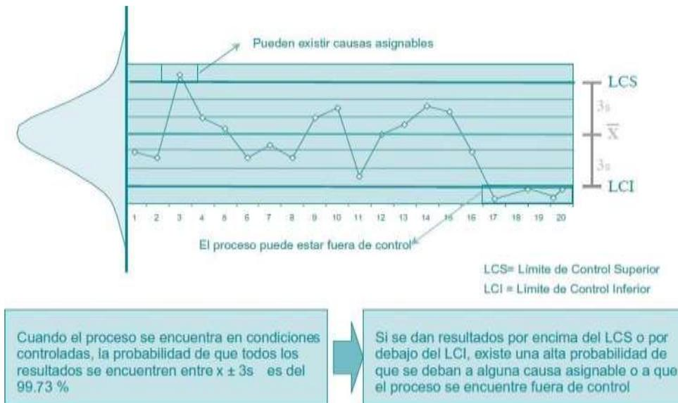
**Figura 15. Esquema para la interpretación de un gráfico de control.**
